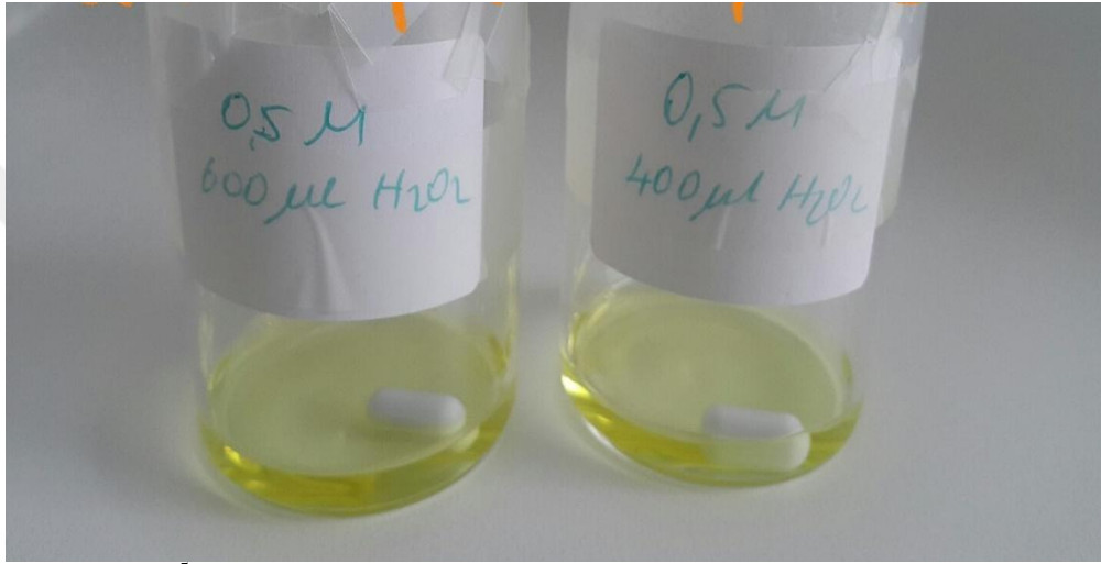
Şekil 4.3. 3,5 \times 10^{-5} M HABA'nın 0,04 M BR tamponu pH: 10,0'da 0,0357 M H 2 O 2 ortamındaki çözeltileri
