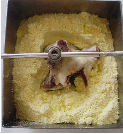
Şekil 3.3. Vertebranın gömme işlemi.A) Sabitleyici çimentonun uygulanışı. B) Sabitleyici çimentonun donduktan sonraki görüntüsü, uygulanan sabitleyici çimentonun pedikül vidasının kemiğe giriş bölgesinde vidaya temas etmemesi sağlandı, sökölme testlerinde örnek çimentolarının alt sabitlemeyi yapacak kelepçelerce kırılmasını engellemek için üstteki u şeklinde destekler her bir örnek için ayrıca hazırlanmıştır.
