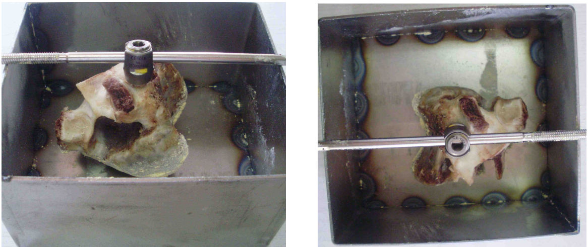
Şekil 3.2. Pedikül vidası uygulanmış vertebranın gömme kabındaki görüntüsü. Tüm vertebralarda sökölme kuvvetinin aksiyel yönde uygulanabilmesi için 5.0mm şanz kullanılarak pedikül vidası sabitlenmiştir. Gömme işlemlerinde vertebraların gömme kablarına tamamen yerleştirilebilmesi için spinöz ve transvers süreçler kesilmiştir.
