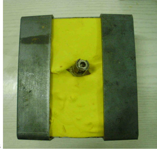
Şekil 3.3. Vertebranın gömme işlemi.A) Sabitleyici çimentonun uygulanışı. B) Sabitleyici çimentonun donduktan sonraki görüntüsü, uygulanan sabitleyici çimentonun pedikül vidasının kemiğe giriş bölgesinde vidaya temas etmemesi sağlandı, sökölme testlerinde örnek çimentolarının alt sabitlemeyi yapacak kelepçelerce kırılmasını engellemek için üstteki u şeklinde destekler her bir örnek için ayrıca hazırlanmıştır.
