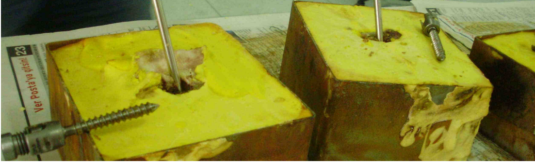
Şekil 3.5. Pedikül yollarının belirlenmesi. Sökölme testlerini takiben çıkarılan pedikül vidaları kendi gömme kaplarının üzerine konuldu ve pedikül yolları ince rodlarla belirlendi.
