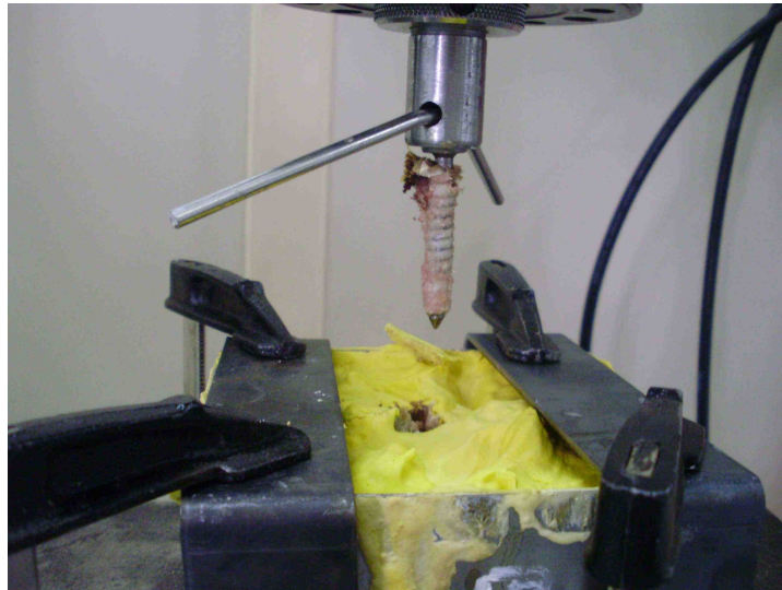
Şekil 3.6. Sökölme testlerinin sonlandırılması. 1.basamak ve 2.basamak sökölme testleri vidanın kemikten kurtulduğu ana kadar devam ettirildi.
