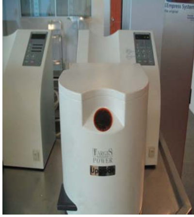
Şekil 3.1.3.3. Targis Power Upgrade ısı-ışık polimerizasyon cihazı
