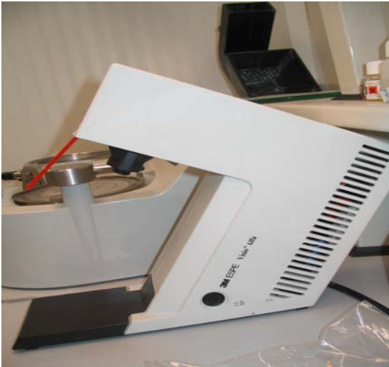
Şekil 3.1.5.2. 3M Espe Visio Alfa polimerizasyon cihazı
