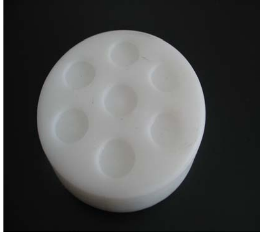
Şekil 3.1.1.1. Kompozit örneklerin hazırlandığı teflon kalıp
