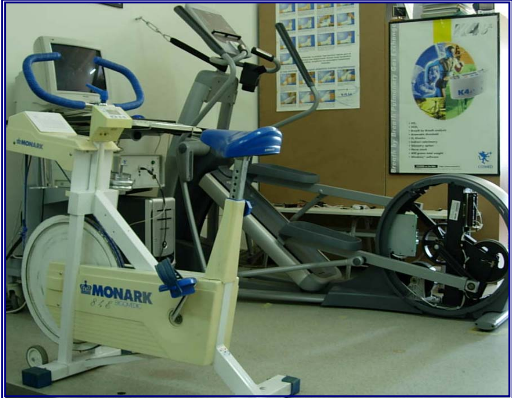
Resim A: EW modifikasyonu için kullanılan Precor marka EFX576i model Eliptik Kayak Kros Simülatörü ve orijinal BW Testlerinde Kullanılan Monark marka 843 model bisiklet ergometresi.
