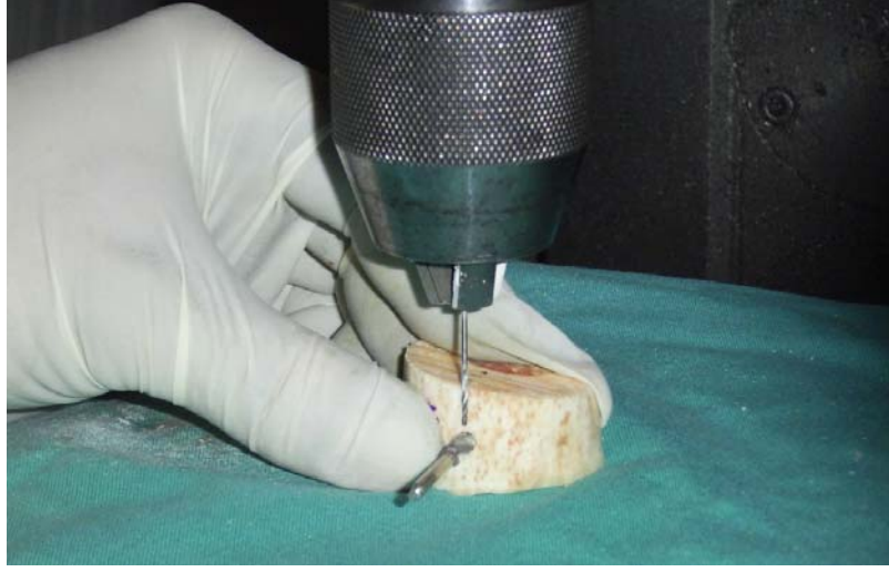
Şekil 11. Freze Cihazı kullanılarak Termocouple deliklerinin açılması
