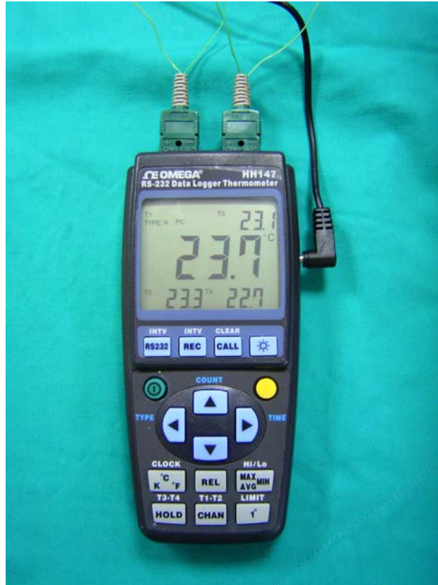
Şekil 8. Sıcaklık ölçümünde kullanılan termometre
