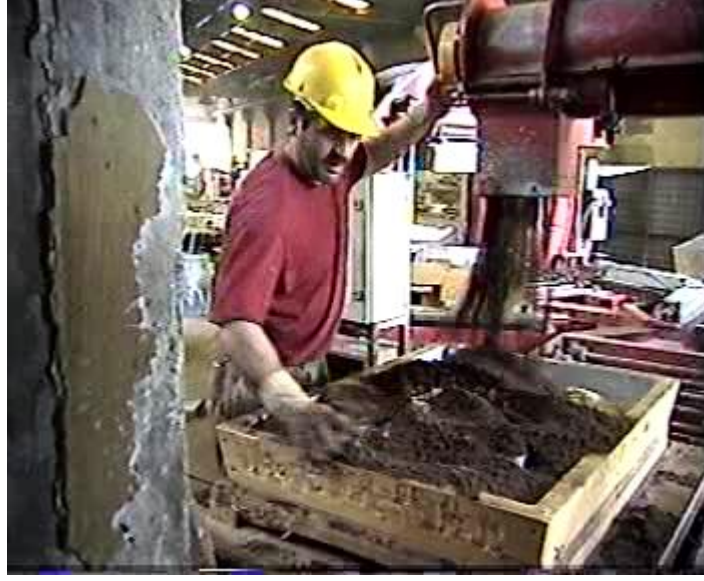
Şekil 14 – Maça Kalıp Yapımı -1
