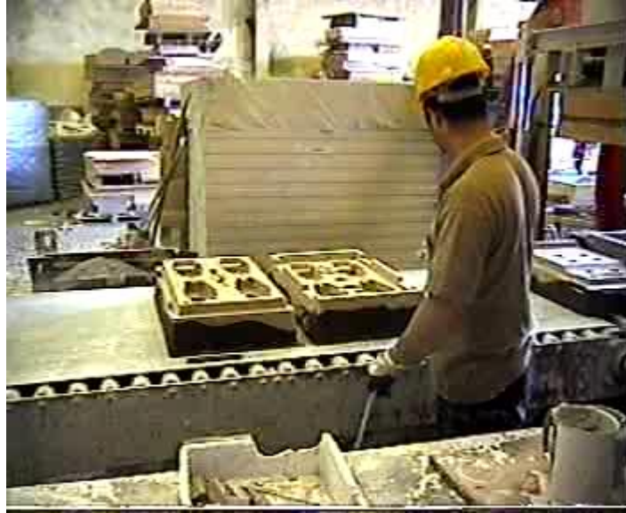
Şekil 15 – Maça Kalıp Yapımı -2
