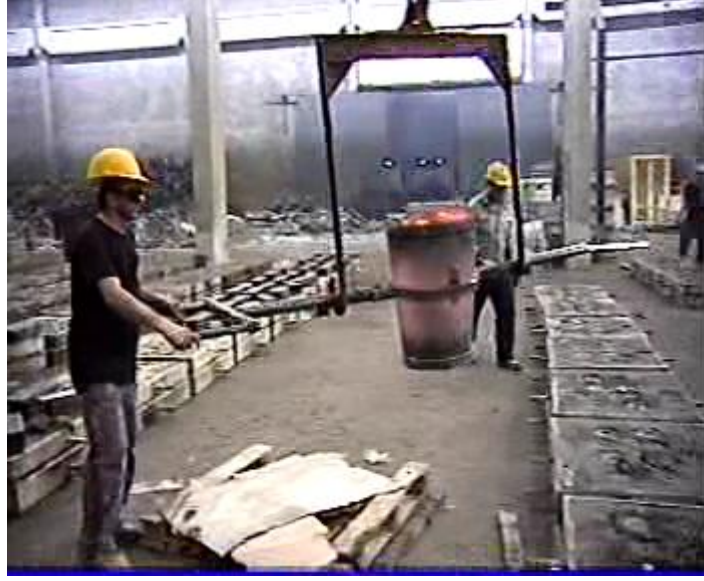
Şekil – 18 Döküm Potalarının Taşınması
