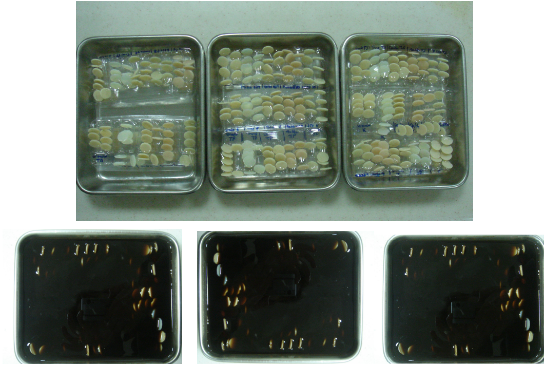
řekil 3.5.2: Hazırlanan rneklerin metal kvetler ierisine yerleřtirilmesi ve kahve solsyonunda bekletilmesi
