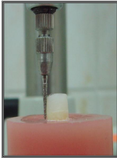
Şekil 3.9.1 Örneklerin paralelometrede açısının kontrol edilmesi
