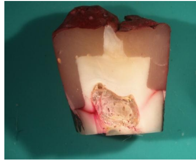
Şekil 4.3: Ra+ Filtek Z250 kompozit grubunda mikrosızıntı tespit edilen bir örnek (x20 büyütme)
