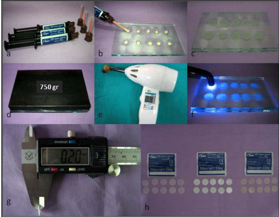
Şekil 3.3.4. a) Universal (A 2 ), beyaz opak ve translusent renklerdeki Maxcem Elite rezin simanlar b) cam plaka üzerindeki, naylon levhadaki boşluklara enjekte edilerek dökülen siman c) alttaki levha üzerine kapatılmış olan ikinci cam plaka d) cam plakalar üzerine paslanmaz çelik standart ağırlık (750 gr) yerleştirilmesi (ağırlık 10 dakika boyunca kimyasal polimerizasyon için bekletildi) e) Hilux LED 250 ışık kaynağı f) ışık kaynağı kullanılarak örneklerin polimerize edilmesi g) levhadan çıkartılan örneklerin kalınlıklarının kontrol edilmesi h) renk ölçümleri için seçilen 10’ar adet uygun universal, beyaz opak ve translusent renklerdeki Maxcem Elite (Res-I) rezin siman örnekler
