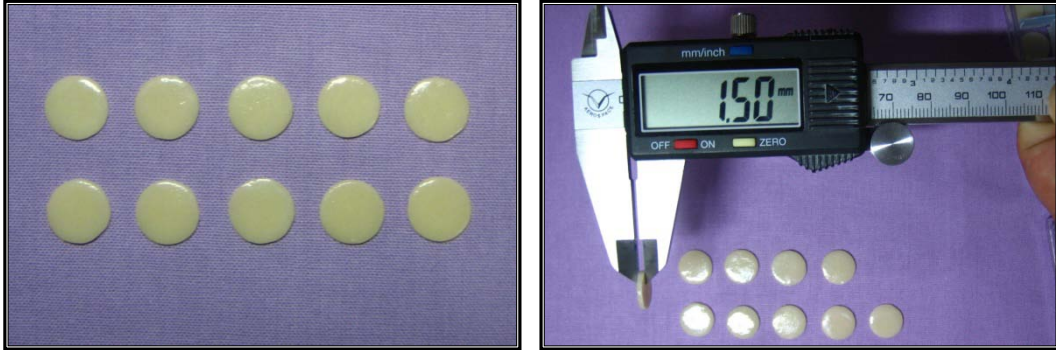
Şekil 3.1.20 VITA In Ceram Alumina tam seramik örnekler ve kalınlıklarının kontrol edilmesi
