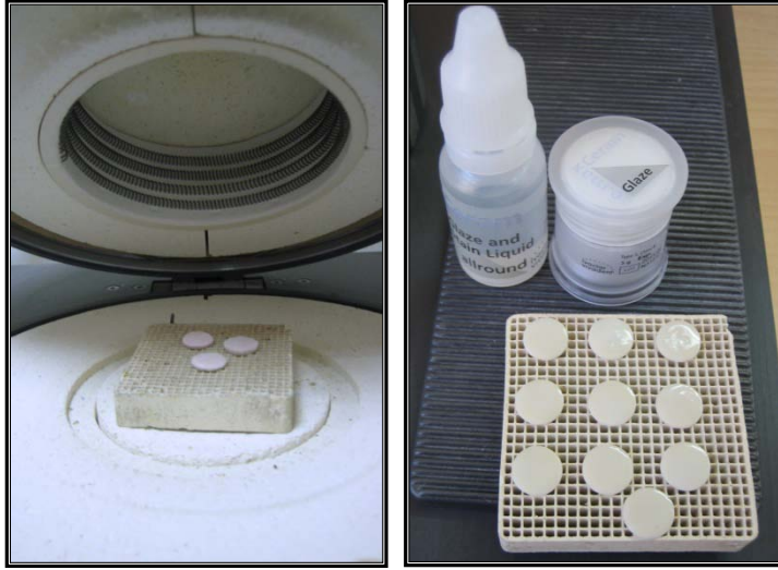
Şekil 3.1.13 IPS e-max Ceram tabakalama seramiği koyularak fırınlanan örnekler, glaze materyalinin uygulanması
