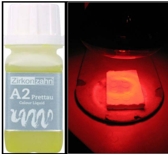
Şekil 3.1.25 Örneklerle renk solüsyonu uygulanarak, kızılötesi lambada renklendirme işlemi yapılması
