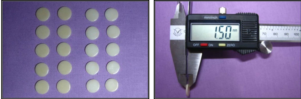
Şekil 3.1.14 Tüm IPS e-max örnekler ve kalınlıklarının kontrol edilmesi
