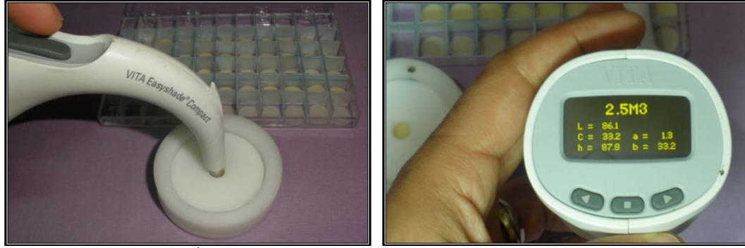
Şekil 3.4.5 İkinci spektrofotometrik renk ölçümünün gerçekleştirilmesi
