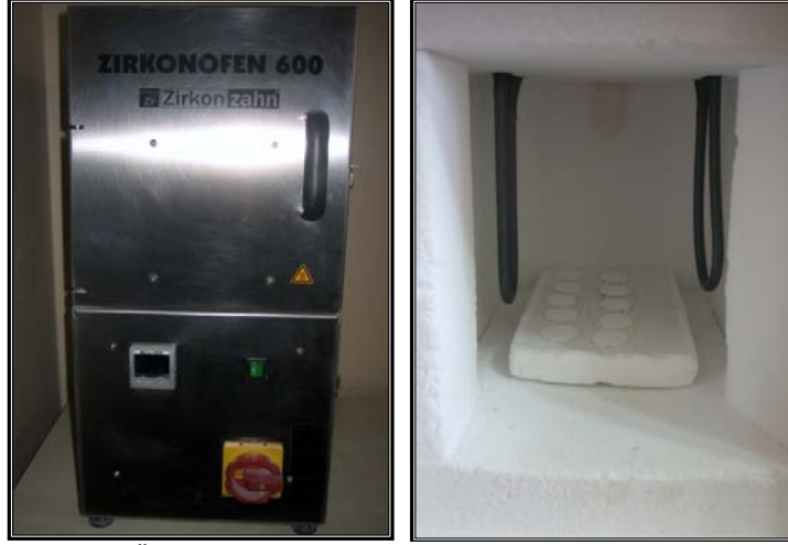
Şekil 3.1.26 Örneklerin sinterleme fırınına yerleştirilerek sinterlenmesi
