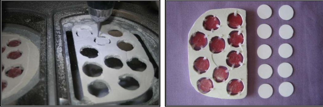
Şekil 3.1.24 Örneklerin dikkatlice bloktan çıkartılması ve kontrol edilmesi
