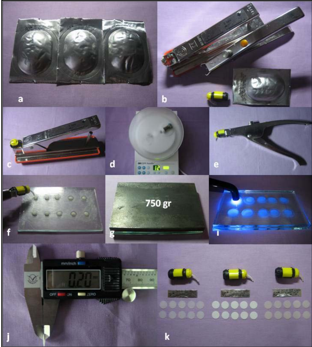
Şekil 3.3.7. a) Universal (A 2 ), beyaz opak ve translüsent renklerdeki RelyX Unicem rezin simanlar b) siman materyali ve karıştırma tabancaları c) karıştırma tabancasına yerleştirilmiş kapsül d) Roromix karıştırıcıya yerleştirilmiş kapsül e) uygulama tabancasına yerleştirmiş kapsül f) cam plaka üzerindeki naylon levhadaki boşluklara enjekte edilerek dökülmüş siman g) cam plakalar üzerine paslanmaz çelik standart ağırlık (750 gr) yerleştirilmesi (ağırlık 10 dakika boyunca kimyasal polimerizasyon için bekletildi) h) ışık kaynağı kullanılarak örneklerin polimerize edilmesi j) levhadan çıkartılan örneklerin kalınlıklarının kontrol edilmesi k) renk ölçümleri için seçilen 10'ar adet uygun universal, beyaz opak ve translüsent renklerdeki RelyX (Res-IV) rezin siman örnekler
