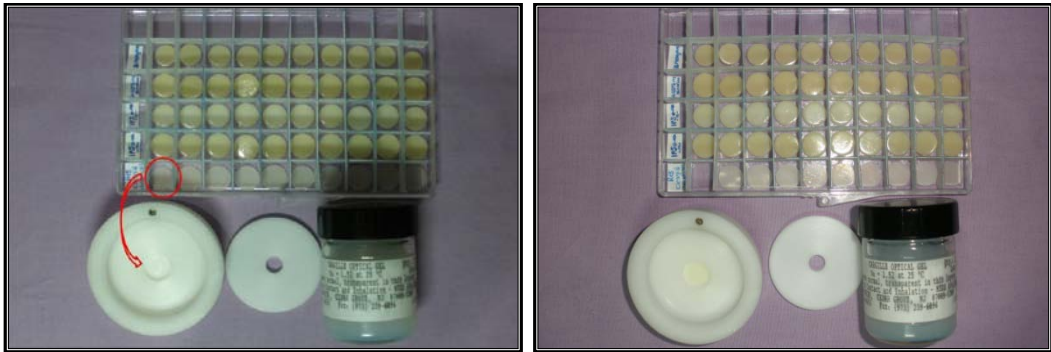
Şekil 3.4.2 Plastik kaba yerleştirilmiş bir siman grubu ve bu gruba ait ilk örneğin poliasetat kalıba konulması
