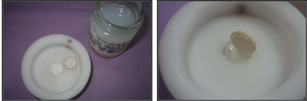
Şekil 3.4.6 Kırılma indisi materyali ile bağlanan siman ve seramik örnekler
