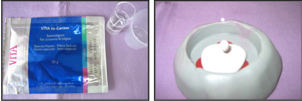
Şekil 3.1.16 Patern rezin örneklerin VITA In Ceram revetman kalıba alınması
