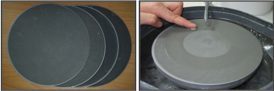
Şekil 3.1.10 Örnek yüzeylerinin su soğutması altında zımparalama cihazında düzeltilmesi
