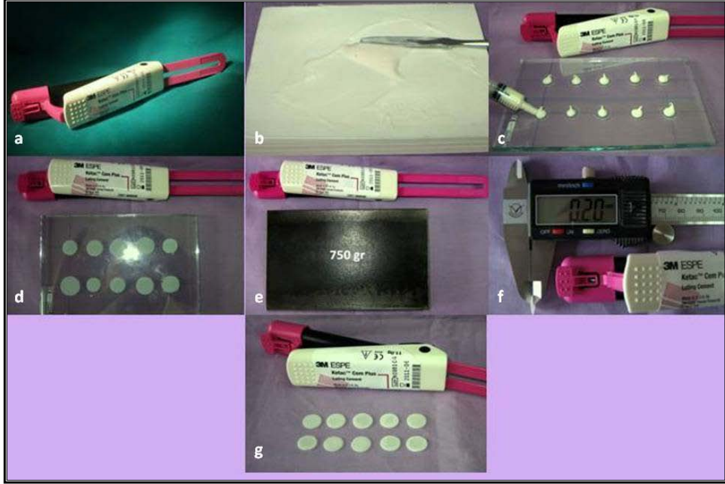
Şekil 3.3.3 a) Ketac Cem Plus rezin modifiye cam iyonomer siman b) 20 saniye boyunca karıştırılmış uygun miktardaki siman materyali c) karışımın dental enjektöre aktarılarak levhadaki yuvalara uygun miktarda dökülmesi d) alttaki levha üzerine kapatılmış olan ikinci cam plaka e) cam plaka üzerine paslanmaz çelik standart ağırlık (750 gr) yerleştirilmesi f) levhadan çıkartılan örneklerin kalınlıklarının kontrol edilmesi g) renk ölçümleri için seçilen 10 adet uygun rezin modifiye cam iyonomer siman örnek
