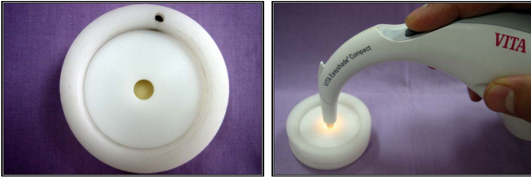
Şekil 3.2.3 Poliasetat kalıbın konumlandırıcı parçasının yerleştirilip renk ölçümünün gerçekleştirilmesi
