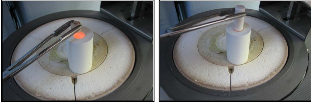
Şekil 3.1.5 Seramik ingot ve itici pistonun manşete yerleştirilmesi
