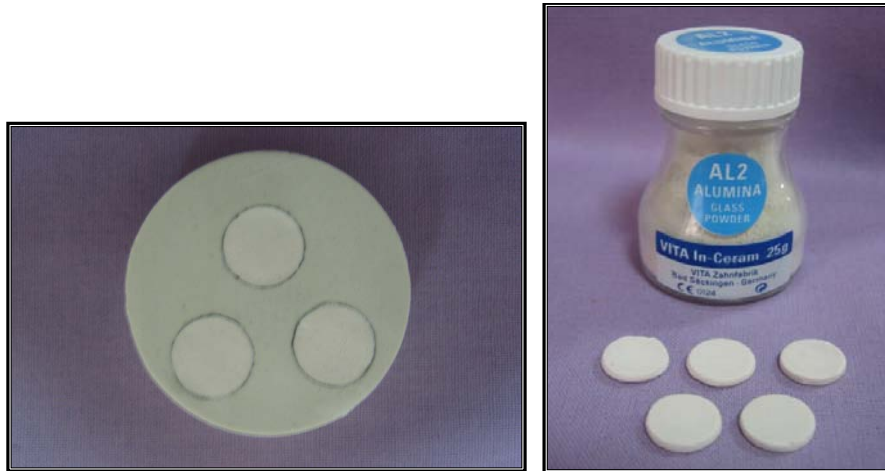
Şekil 3.1.18 Slibin, revetman model üzerinde uygulanması ve sinterlenmesinin ardından, sinterlenmiş örneklerle cam infiltrasyon işlemi uygulandı
