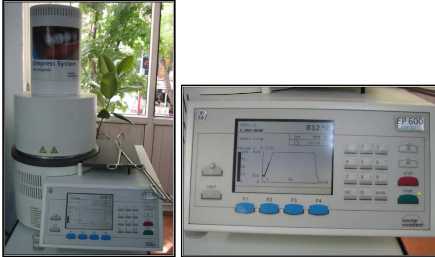
Şekil 3.1.6 IPS EP 600 Presleme fırını ve presleme programı
