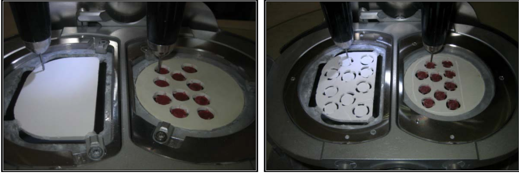
Şekil 3.1.23 Yarı sinterlenmiş örneklerin kazıma yöntemiyle elde edilmesi
