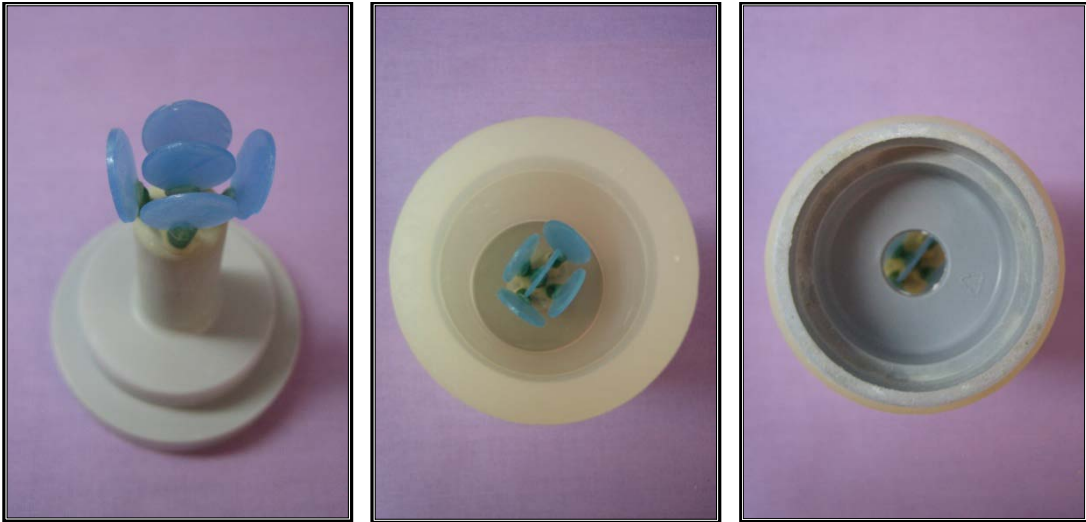
Şekil 3.1.3 Mum örneklerin tijenerek IPS silikon halka ve manşete alınması
