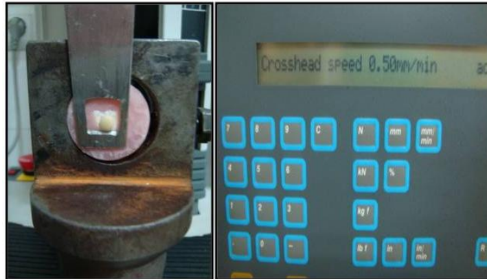
Şekil 3.10. Bağlantı testinin yapıldığı üniversal test cihazı
