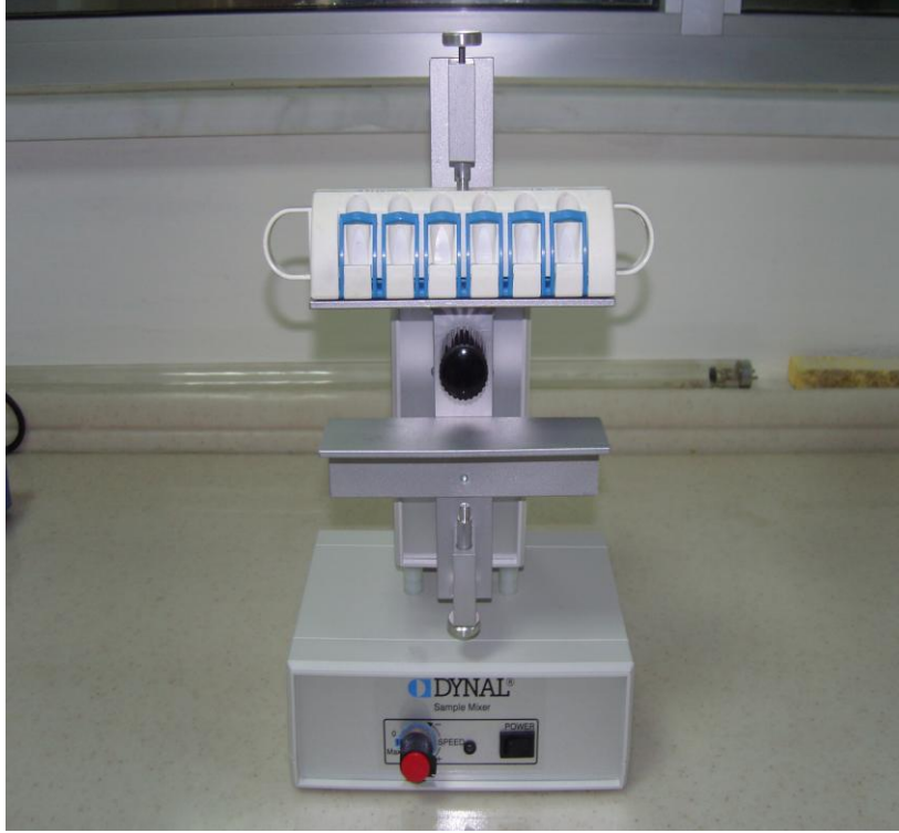
Şekil 6. Dynal MPC-S rakısı ( Dynal Magnetic Particle Concentrator) ile Dynal Magnetic Örnek Karıştırıcısı (Dynal Magnetic Sample Mixer-MX-4)
