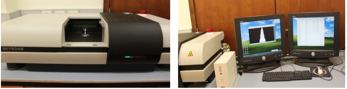
Şekil 3.6: Skyscan 1172 x-ışınlı mikrotomografi kompakt masaüstü sistemi
