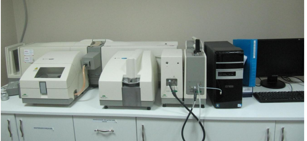
Şekil 16. Dentin partikülleri, boyutlarının standardizasyonu amacıyla kullanılan Malvern Mastersizer 2000 (Malvern, Worcestershire, İngiltere) cihazı.
