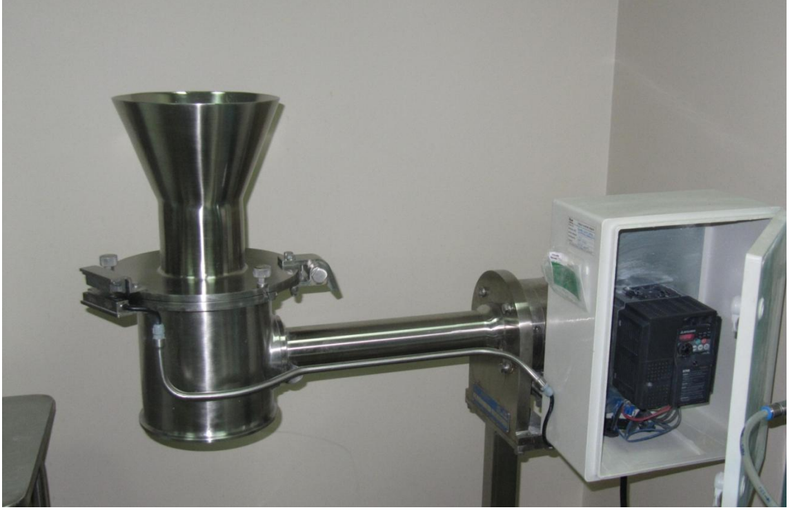
Şekil 14. Dentin parçacıklarını 1200 ve 1500 \mu\text{m} boyutlarında parçalayan özel eleklerle sahip QUADRO R COMIL R (QUADRO, Ontario, Kanada ) cihazı
