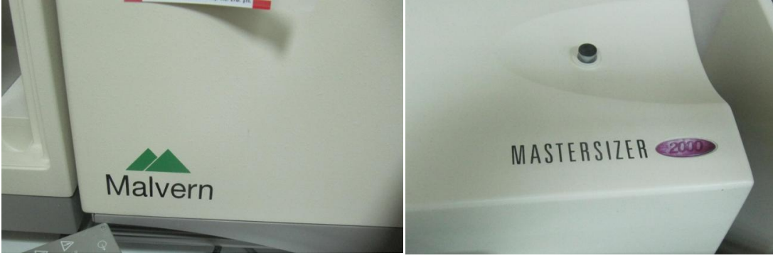
Şekil 17. Dentin partikülleri, boyutlarının standardizasyonu amacıyla kullanılan Malvern Mastersizer 2000 (Malvern, Worcestershire, İngiltere) cihazı.
