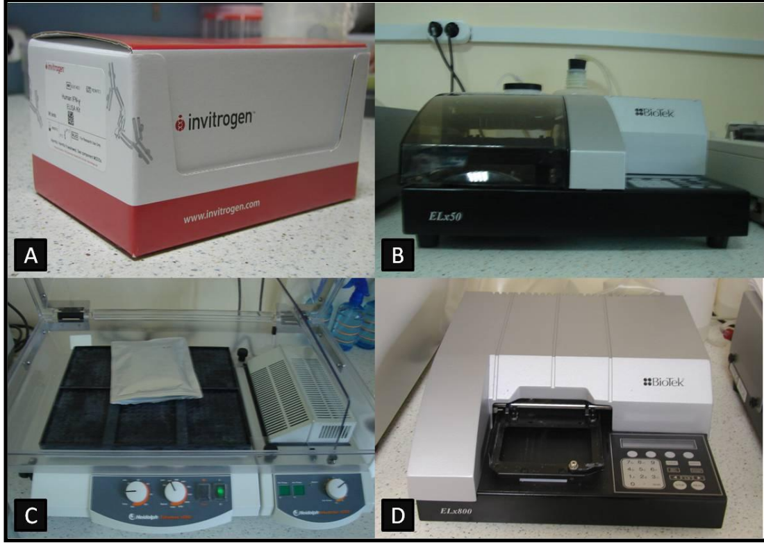
Şekil 3.2.1.A) korumalı kutusunda ELISA kitlerinden bir örnek B) analiz için kullanılan ELISA yıkayıcı C) inkübatör cihazı D) plate içeriklerinin analizini yapan ELISA okuyucu
