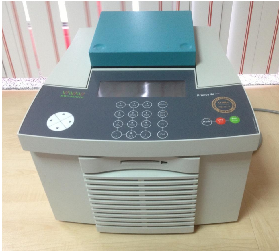
Şekil 6. Gen bölgesinin çoğaltılmasında kullanılan PCR cihazı (MWG Biotech Primus 96-Plus PCR system).
