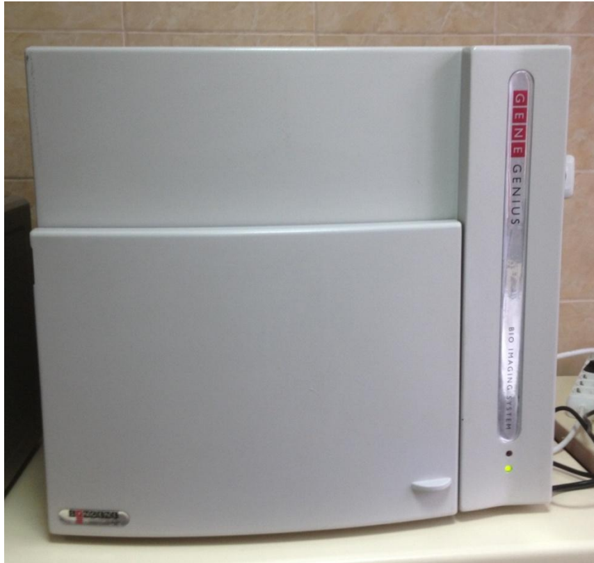
Şekil 7. Polimorfizmler değerlendirildiği jel görüntüleme cihazı (SYNGENE, geneGenius Bio Imaging System).
