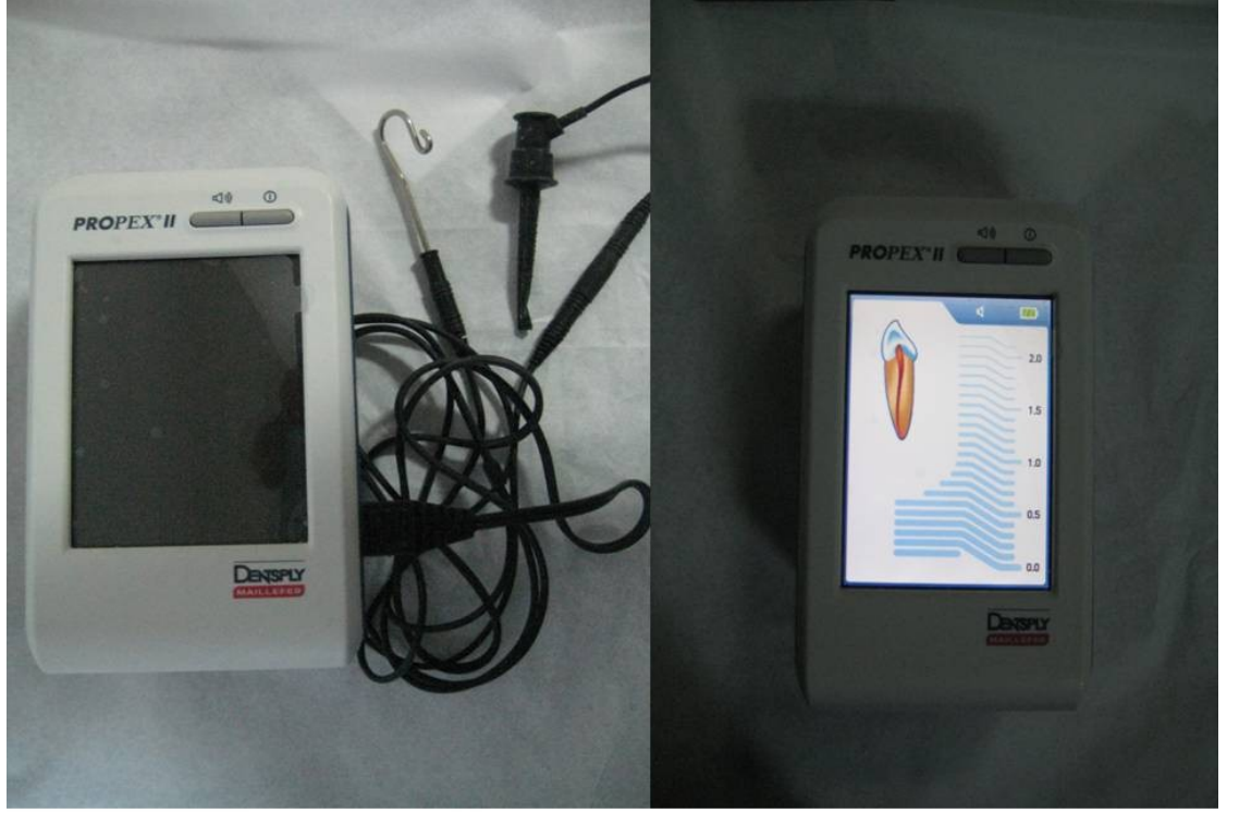
Şekil 8. Çalışmada kullanılan Propex II apeks bulucu cihaz.
