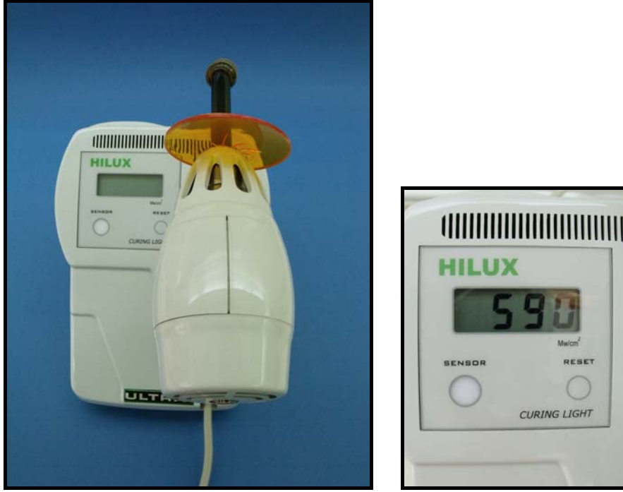
Şekil 10. Hilux Ultra Plus halojen ışık kaynağı ve cihaz üzerindeki ışık yoğunluğu ölçer
