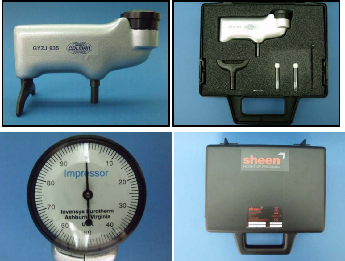
Şekil 12. Barcol yüzey sertlik ölçüm cihazı
