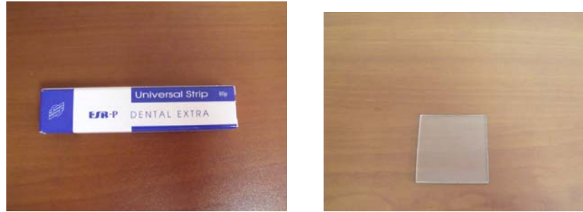
Şekil 14. Örneklerin hazırlanmasında kullanılan şeffaf bant ve cam
