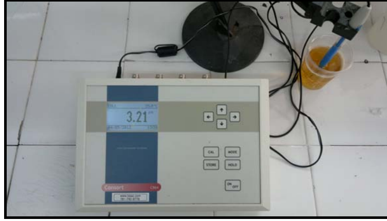
Şekil 9. Sıvıların pH değeri ölçümünde kullanılan multi-parametre analizör
