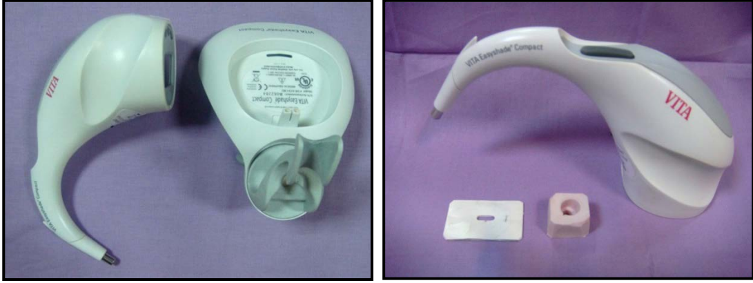
Şekil 28. Renk ölçüm cihazı (solda) ve ölçümün yapılmasında kullanılan kalıp (sağda)
