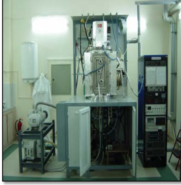
Şekil 16. Manyetik alanda sıçratma sistemi
