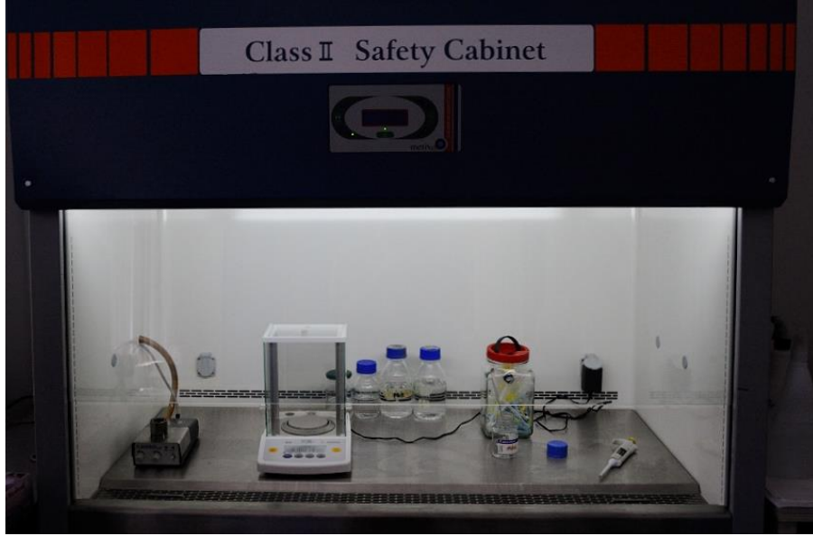
Şekil 9. Kök kanal patlarının hazırlanılmasında kullanılan hassas terazi ve diğer ekipmanlar
