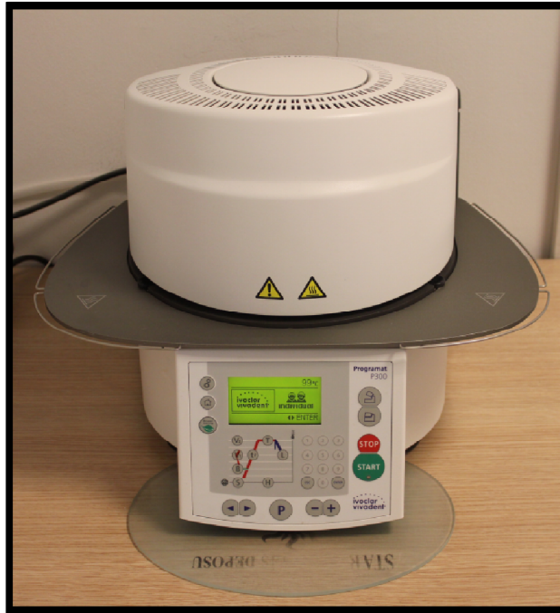
Şekil 31. Çalışmada kullanılan Ivoclar Programat P 300 porselen fırını
