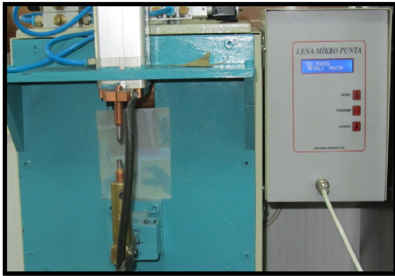
Şekil 19. Punto işlemi için kullanılan punto cihazı
