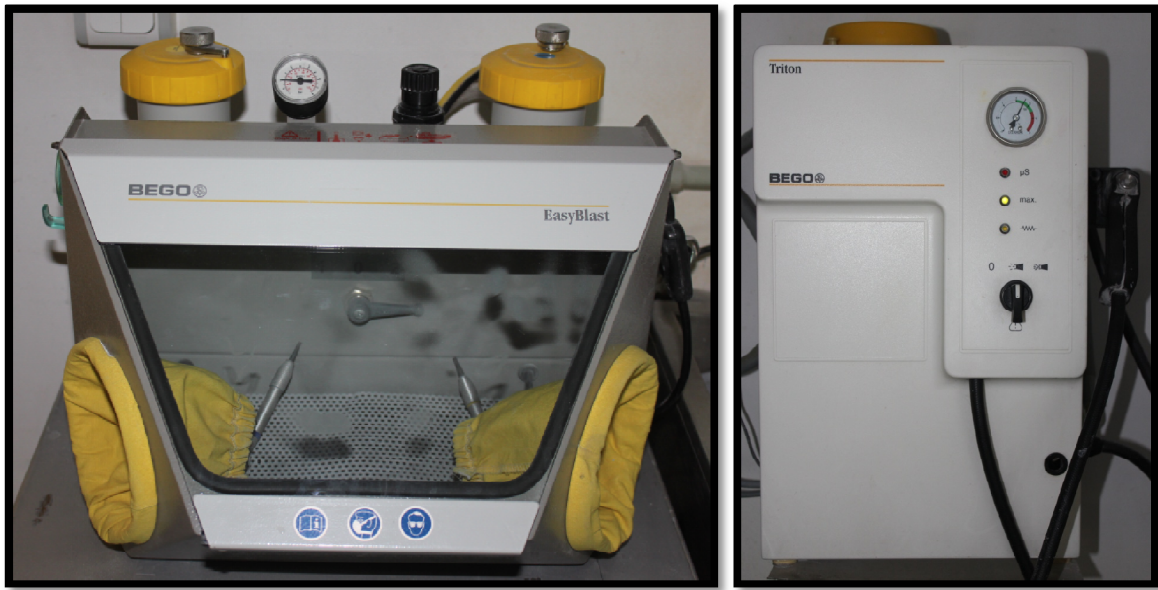
Şekil 16. Çalışmada kullanılan kumlama cihazı ve buhar makinası
