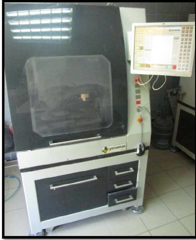
Şekil 9. Titanyum örneklerin hazırlandığı freze makinası
