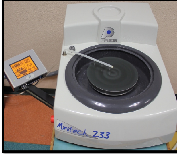
Şekil 11. Çalışmada kullanılan parlatma cihazı
