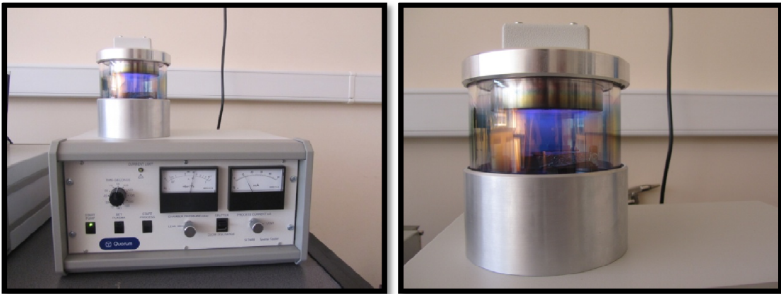
Şekil 39. SEM incelemesi için örnek yüzeylerinin altın kaplanması
