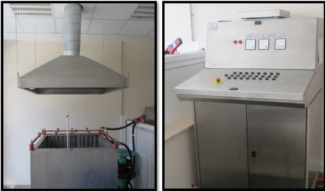
Şekil 20. Mikro ark oksidasyon kaplama cihazı
