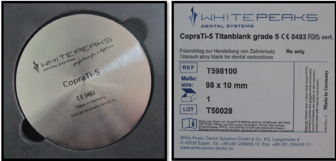
Şekil 10. Örneklerin hazırlanmasında kullanılan titanyum bloklar
