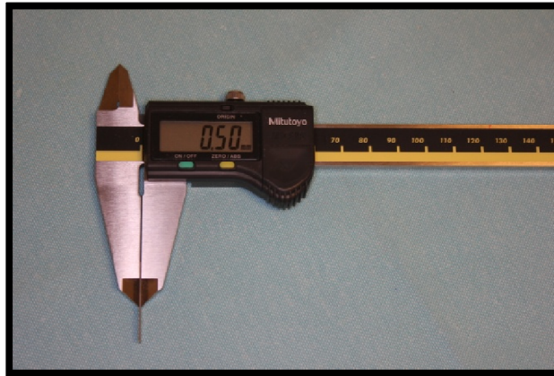
Şekil 13. Titanyum örneklerin kalınlıklarının kontrol edilmesi
