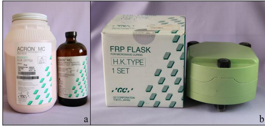
Şekil 11. a. Acron MC mikrodalga ile polimerize olan akrilik rezin b. Mikrodalga fırında kullanıma uygun fiberle güçlendirilmiş mufla
