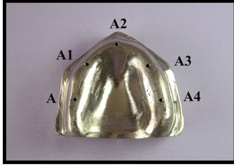
Şekil 7. Metal ana model ve A, A1, A2, A3, A4 noktalarının gösterimi
