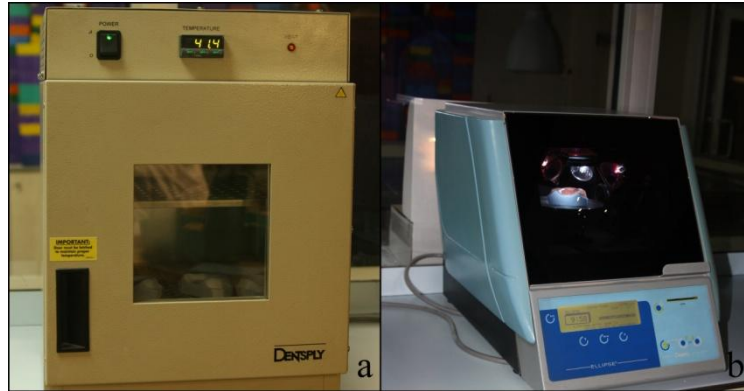
Şekil 8.a. Model Isıtma Fırını b. Işıklı Polimerizasyon Fırını
