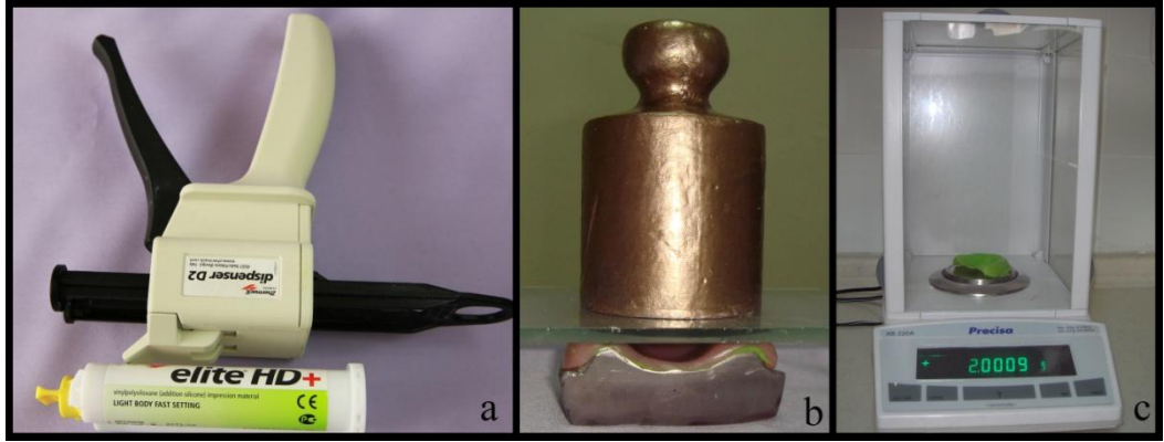
Şekil 16.a. Elite HD polivinil silikon ölçü maddesi b. Ölçü maddesinin model üzerinde adaptasyonu c. Hassas terazide ölçüm
