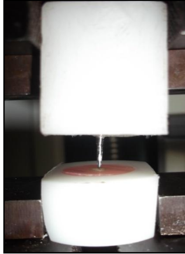
Şekil 3.17. Push-out test düzeneği
