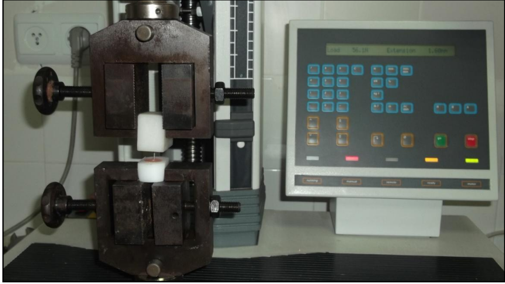
Şekil 3.16. Push-out testinin yapıldığı universal makine
