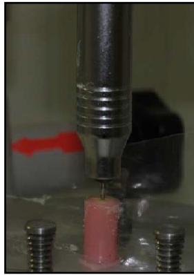
Şekil 3.1 Paralelometre yardımıyla akrile yerleştirilen kök.
