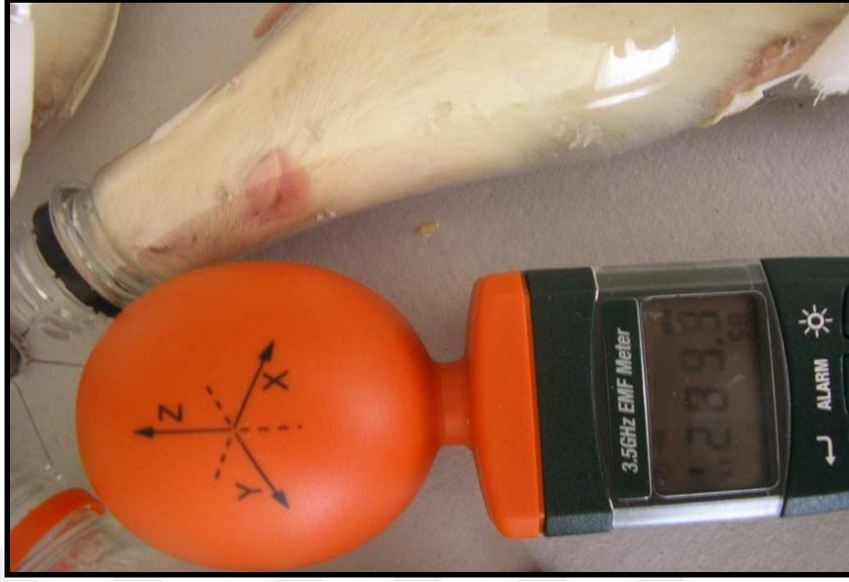
Şekil 14. Elektrik alan ölçer ile hassas ölçüm alımı
