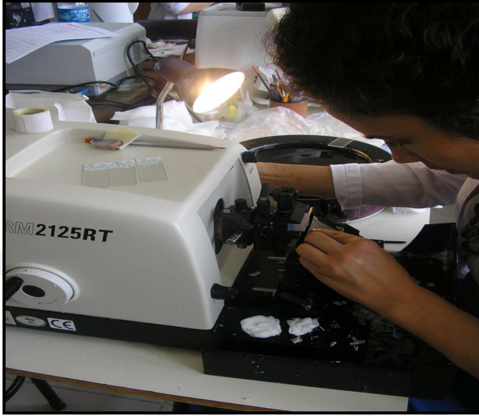
Şekil 17. Rotary mikrotom (Leica RM2125RT) ile kesit alımı
