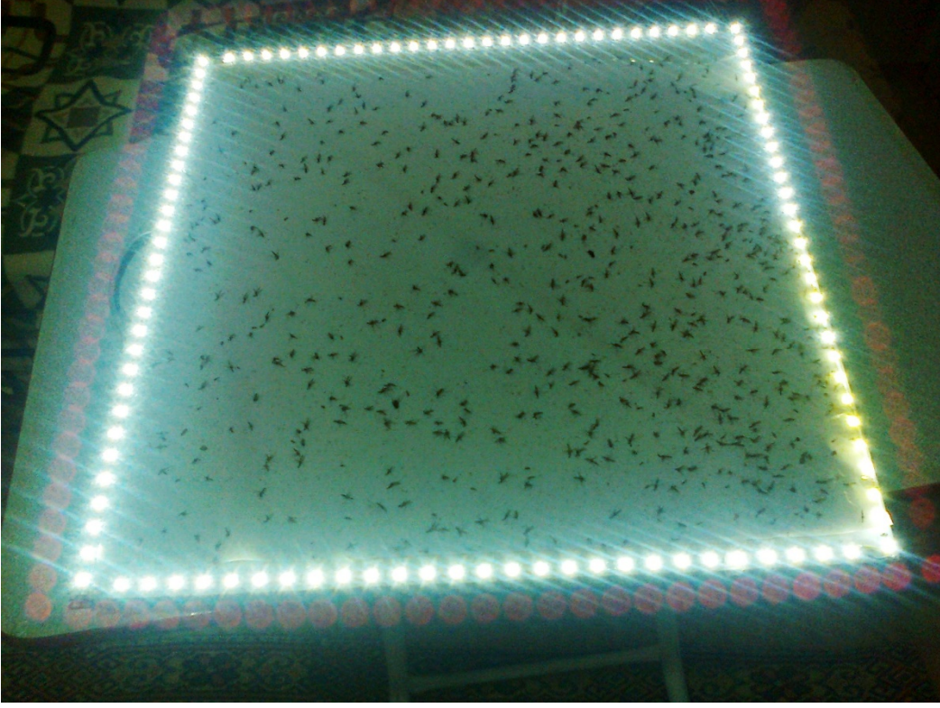
Şekil 14. Led lamba ile modifiye edilmiş tuzakla yakalanan sivrisinek örnekleri
