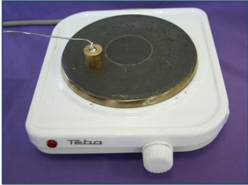
Şekil 26. Pirinç kalıpların ısıtılmasında kullanılan elektrikli ocak
