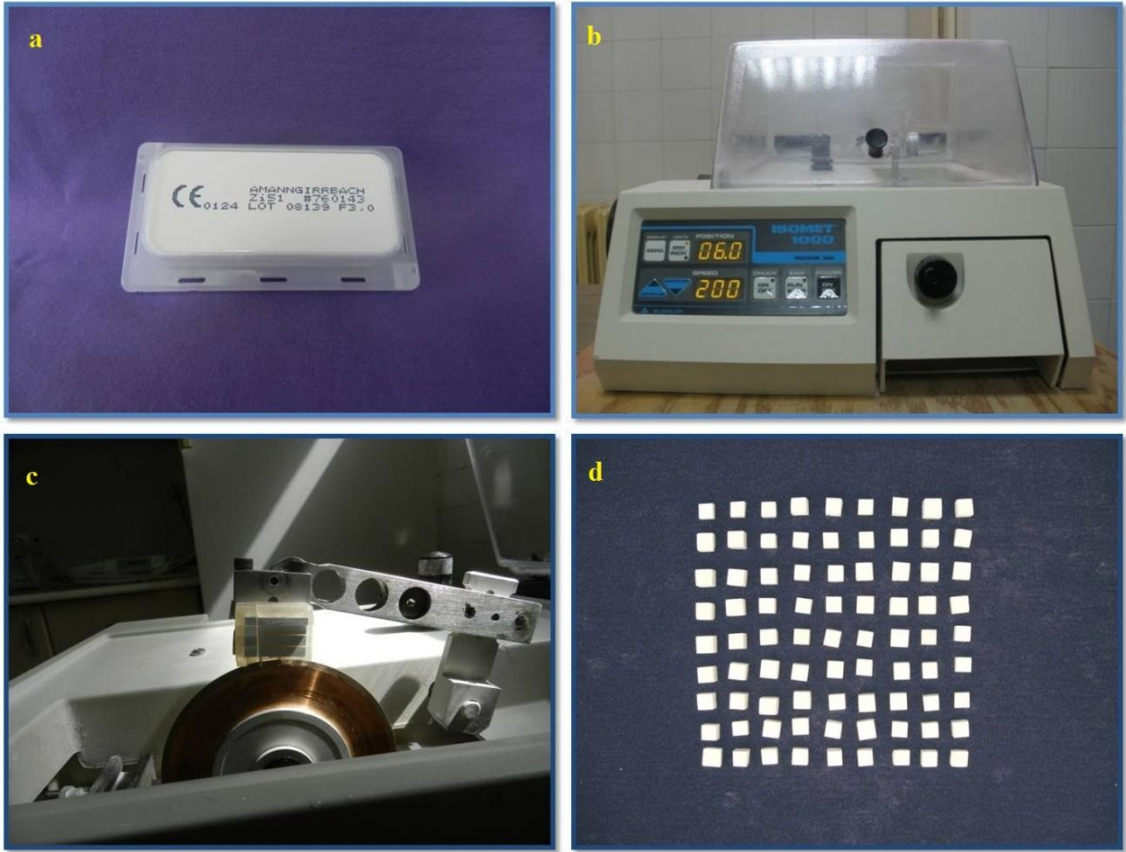
Şekil 11. a. Zirkonyum örneklerin elde edildiği yarı sinterlenmiş blok b. Kesme Cihazı c. Akrile sabitlenmiş yarı sinterlenmiş blok ve kesme bıçağı d. Elde edilen yarı sinterlenmiş zirkonyum örnekler
