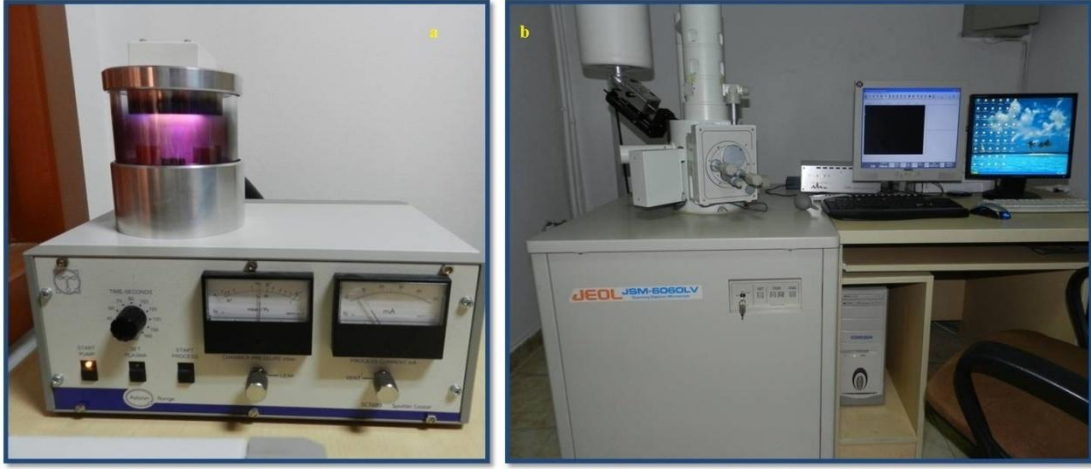
Şekil 34 a. Örneklerin altın ile kaplanması b. Taramalı elektron mikroskobu cihazı
