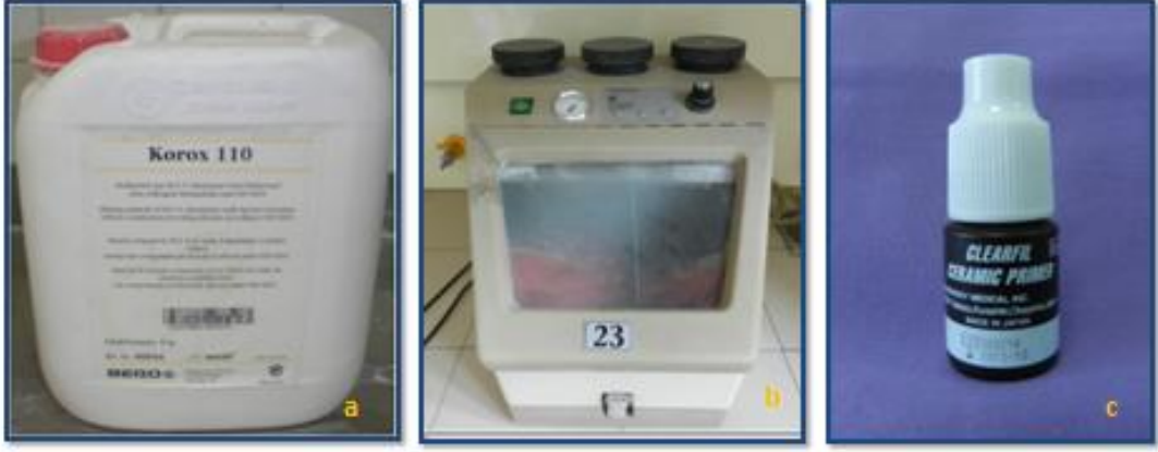
Şekil 17 a. 110µm 'lik Al 2 O 3 kumu b. Kumlama Cihazı c. Silan Bağlayıcı Ajan
