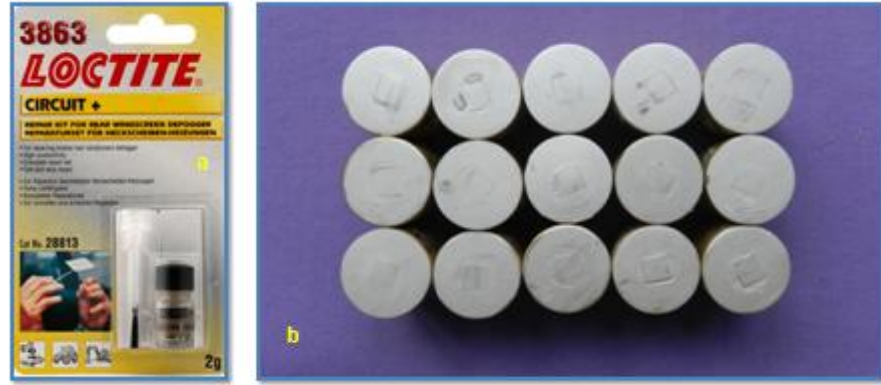
Şekil 32 a. İletken gümüş içerikli tamir kiti (Loctite 3868, Henkel Loctite, İrlanda) b. İletken tabaka ile kaplanmış zirkonyum örnekler
