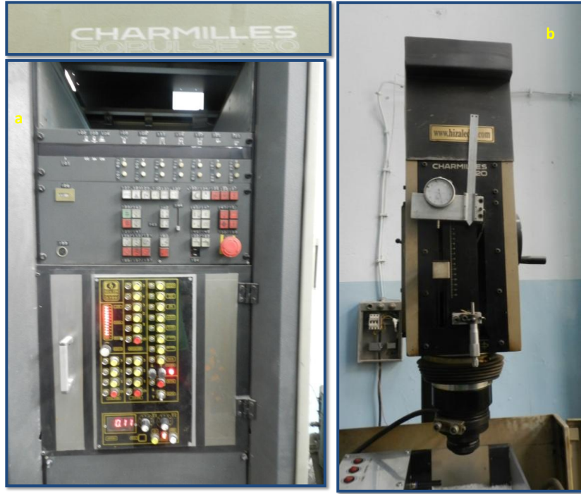
Şekil 29. Elektro Erozyon Tezgahı (Charmilles Isopulse 80) a. Güç Jeneratörü b. Servo kontrollü elektrot besleme ünitesi
