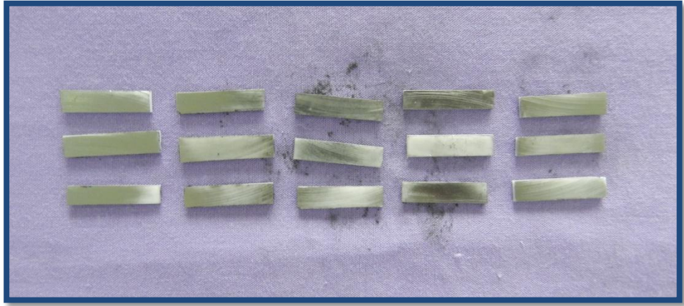
Şekil 42. Grafit Tozu ile kaplanmış seramik örnekler
