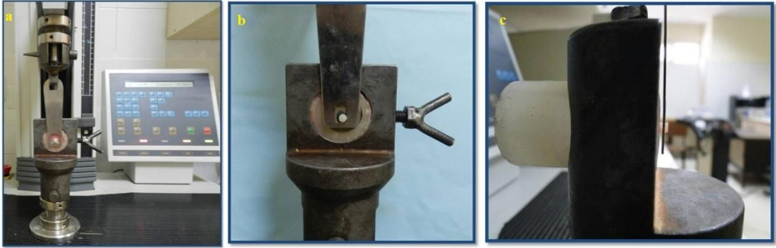
Şekil 38. Üniversal test cihazı ve makaslama testinin yapılması
