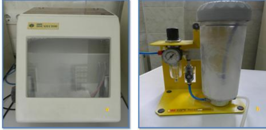
Şekil 19 a. Rocatec kumlama cihazı b. Rocatec Junior Silika Kaplama Modülü
