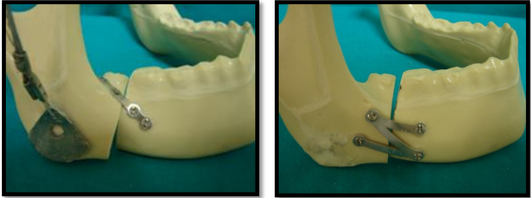
Şekil 35. Deney sonunda mandibula modellerinde görülen eğilme ve linguale doğru torsiyon örnekleri
