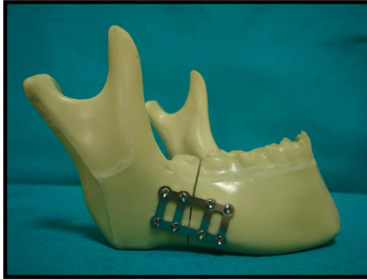
Şekil 29. Sekiz delikli 3D mini plak ile fiksasyonu yapılmış model
