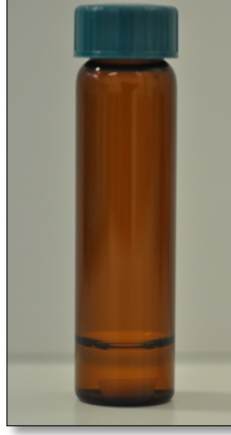
Şekil 11. Işık geçirmeyen cam tüpte solüsyon içerisinde kompozit rezin örnek
