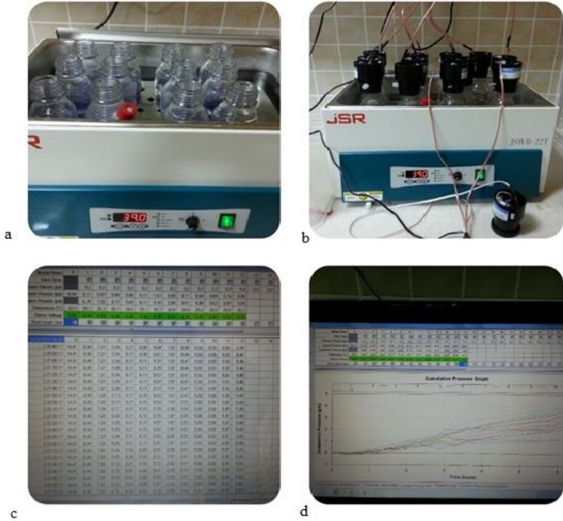
Şekil 4. In-vitro gaz üretim sisteminde kullanılan şişeler (a), şişelerin modül başlıkları (b), modüllerden gelen verilerin kablosuz dizüstü bilgisayarda kaydedilmesi (c, d)
