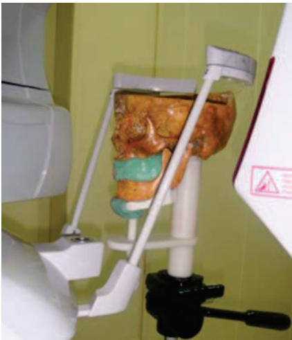
Şekil 8. Mandibulanın sabitlenmesi ve deney düzeneğine yerleştirilmesi
