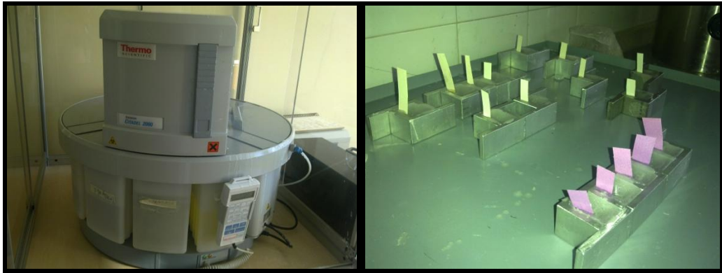
Şekil 13. Doku takip cihazı ve doku takibi sonrasında L demirine gömülmüş beyin dokuları
