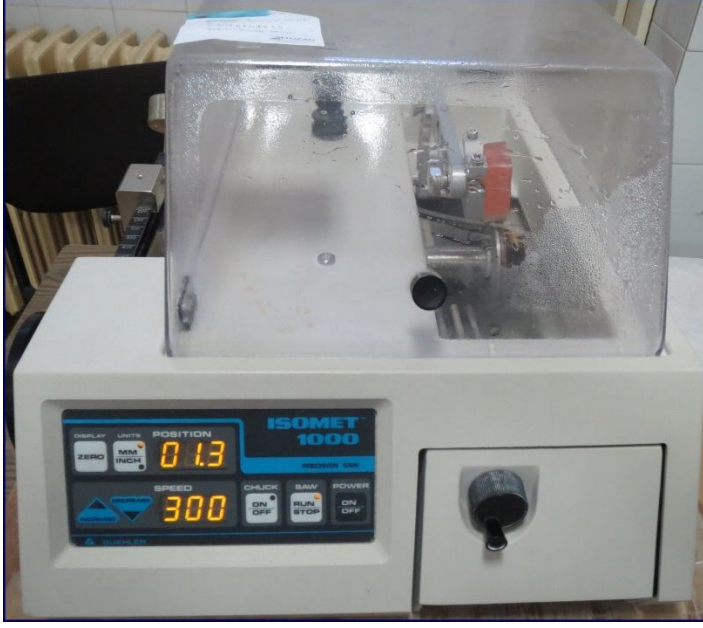
Şekil 17. Kesme işleminin su soğutması altında yapılması
