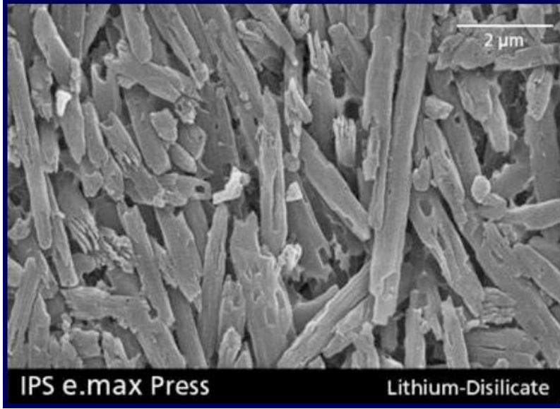
Şekil 3. IPS e.max Press'in mikroyapısı ( http://www.roedentallab.com/downloads/emaxpressdata.pdf , 2014)
