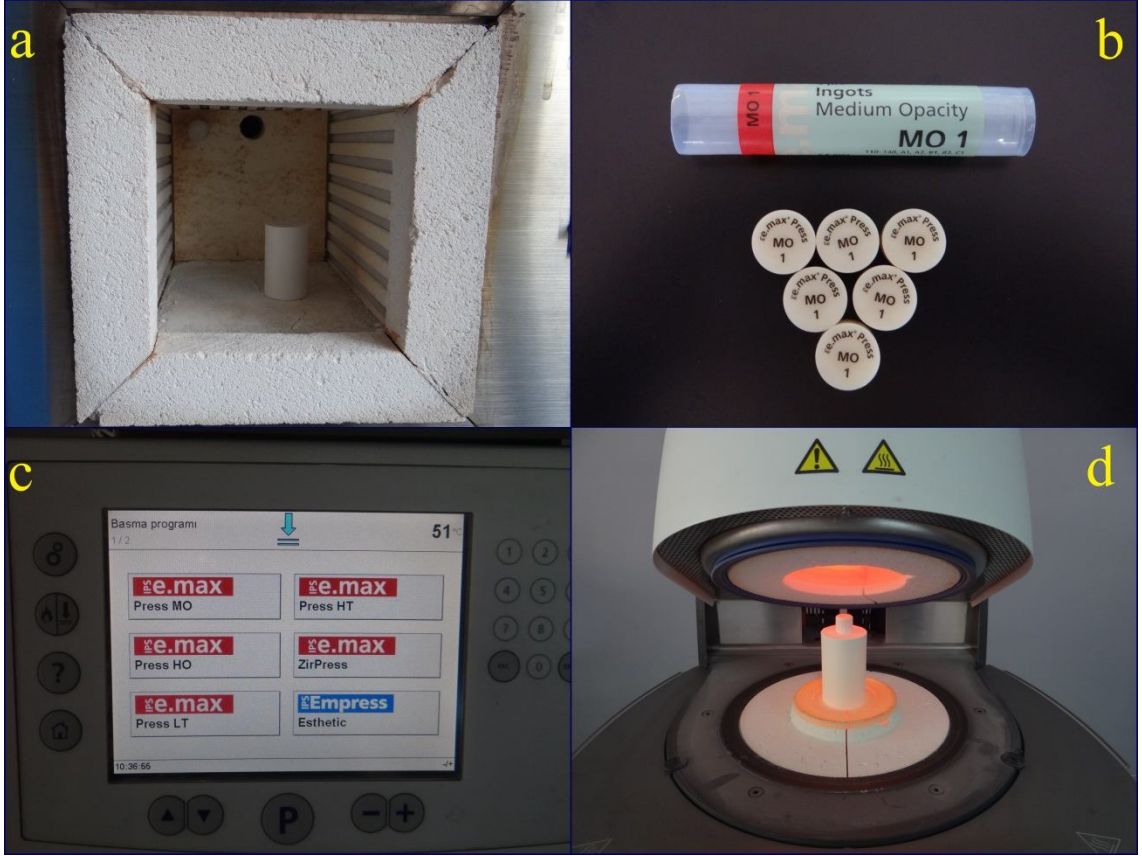
Şekil 6. a. Manşet fırınında mum eliminasyonu b. IPS e.max Press seramik ingotlar c. Presleme fırınında uygun programın seçilmesi d. İngotları ve pistonu taşıyan manşetin presleme fırınına yerleştirilmesi
