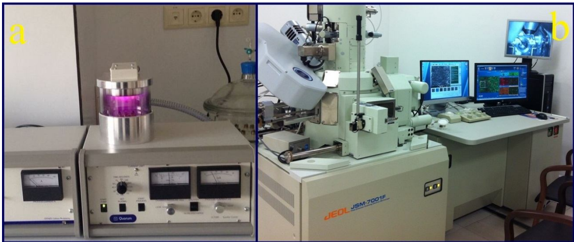
Şekil 25.a. Örneklerin altın ile kaplanması b. Taramalı elektron mikroskobu
