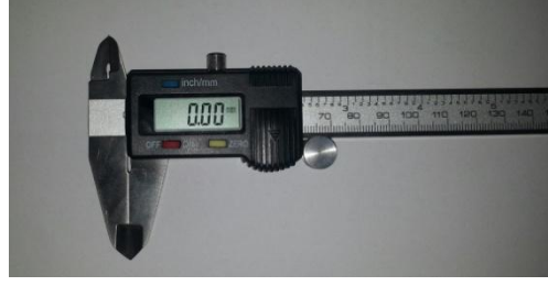
Şekil 46. Ağız açıklığı ölçümünde kullanılan dijital kumpas (Altaş, 905 model, İstanbul)
