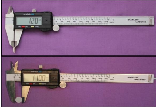
Şekil 22. Örneklerin çap ve kalınlıklarının kontrol edilmesi
