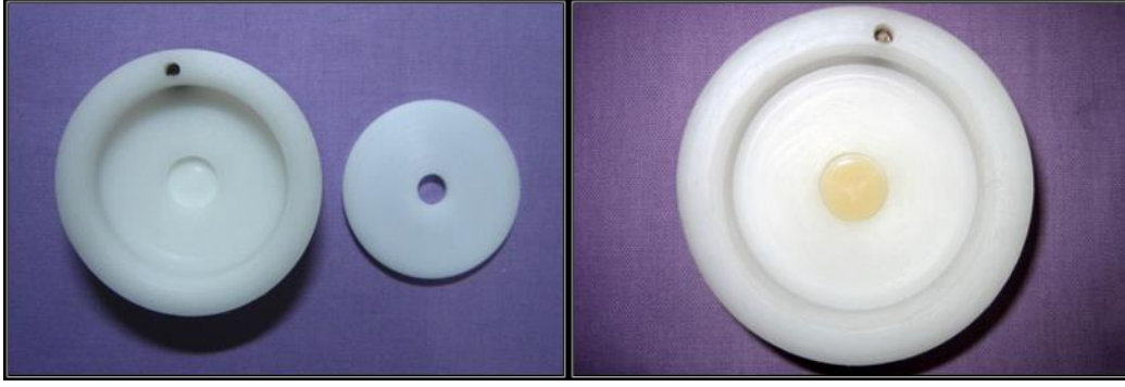
Şekil 31. Poliasetat kalıbın parçaları ve seramik örneğin kalıbın birinci parçasına yerleştirilmesi
