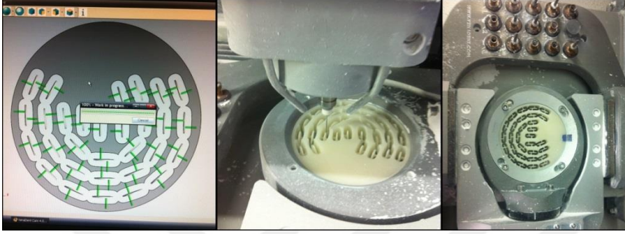
Şekil 11. Plastik örneklerin hazırlanması
