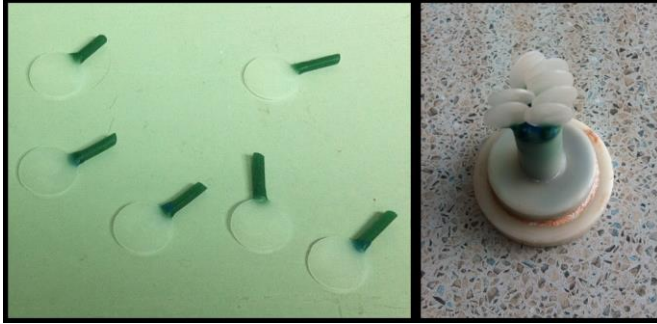
Şekil 12. Hazırlanan plastik örneklerin tijlenmesi ve manşete yerleştirilmesi
