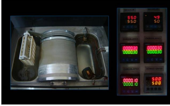
Şekil 33. Çalışmada kullanılan termal siklus uygulama cihazı
