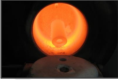
Şekil 13. Manşetin ön ısıtma fırınındaki duruşu
