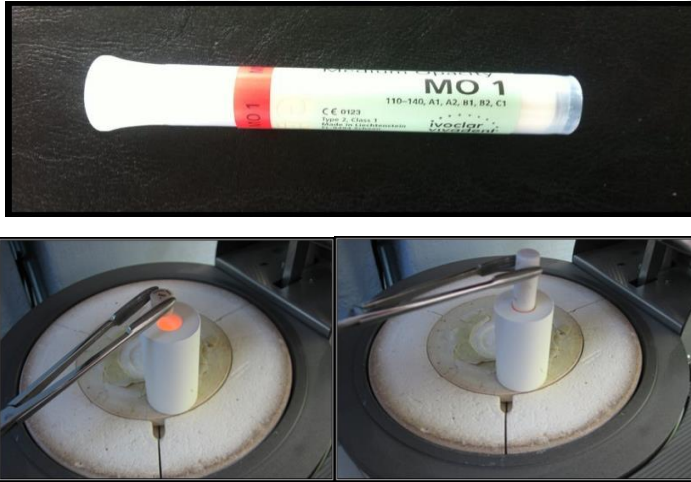
Şekil 14. Seramik ingot ve itici pistonun manşete yerleştirilmesi
