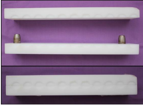
Şekil 19. Tabakalama seramiğinin uygulanması için hazırlanan teflon kalıp
