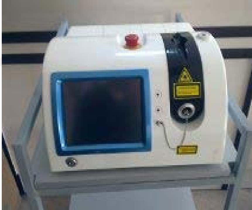
Resim 9b. 980 nm dalga boyuna sahip 1.grup hastalarda işlem için kullanılan lazer sistemi
