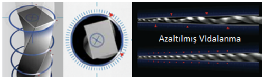
Şekil 11. PTN aletlerinin dikdörtgen kesit formu ve asimetric dalgali hareket dizayni
