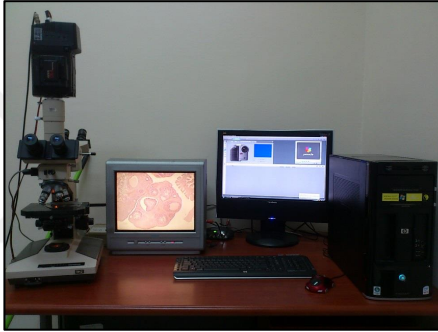
Şekil 19. Kesit örneklerinin değerlendirildiği, eşdeğer alanlarının kaydedildiği ve sayımın yapıldığı mikroskop ve bilgisayar düzeneği
