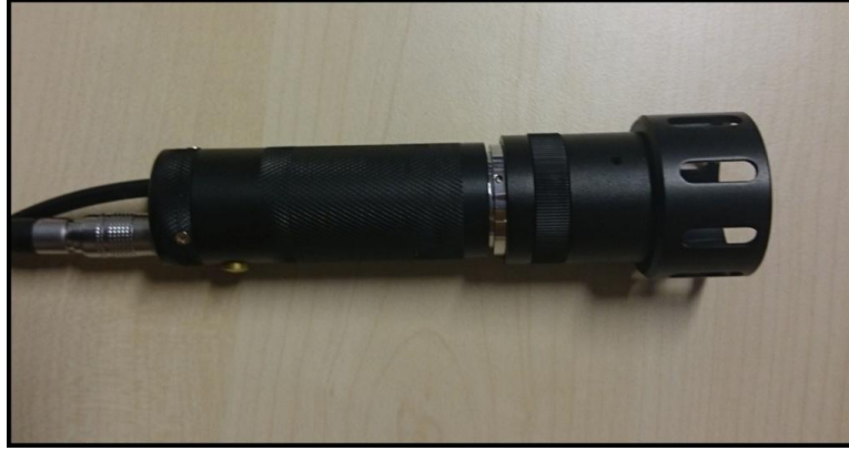
Şekil 9. LLLT uygulama aparatı (Cheese™, Wuhan Gigaa Optronics Technology Co., Ltd., China)
