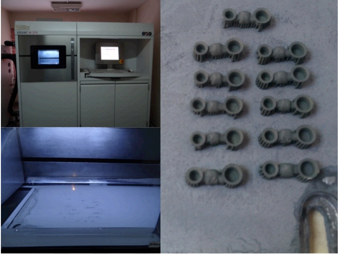
Şekil 20. DMLS makinesinde metal altyapıların üretimi
