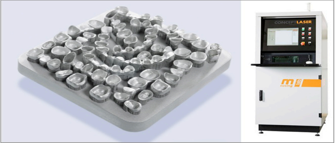
Şekil 7. LaserCusing® sistemi ile üretilen metal altyapılar (www.concept-laser.de/en/industry, 2014'den uyarlanmıştır)
