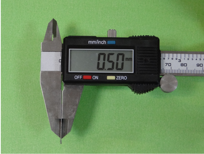
Şekil 45. Örnek kalınlığının ölçülmesi
