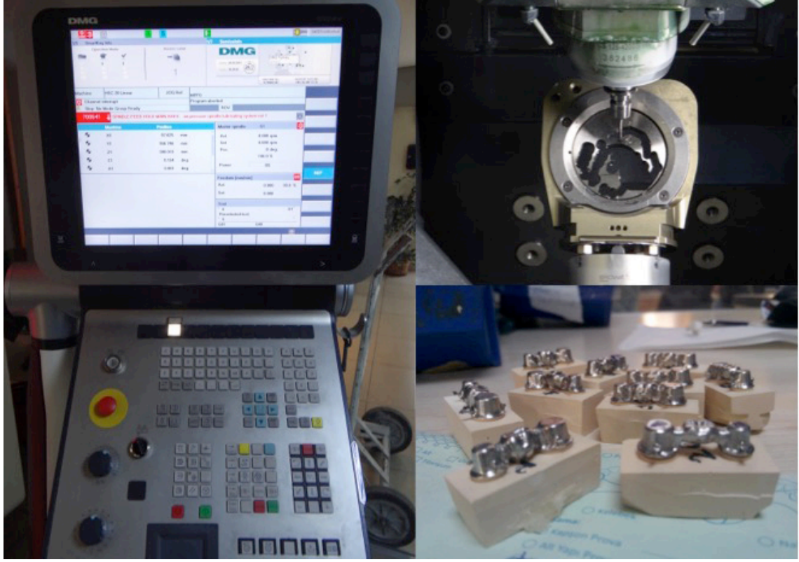
Şekil 19. Milling ünitesinde metal altyapıların üretimi
