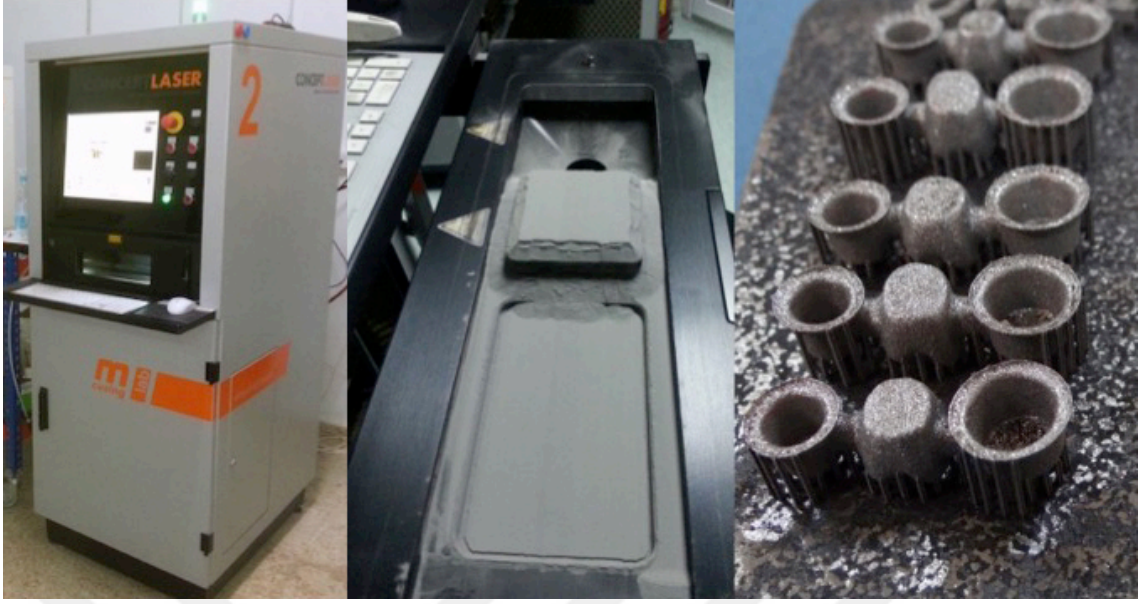
Şekil 21. LaserCusing® makinesinde metal altyapıların üretimi
