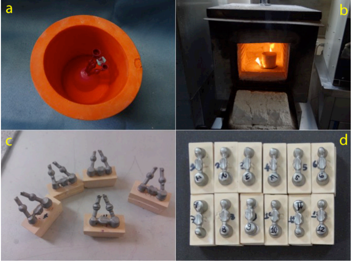
Şekil 17. a. Manşete alınan mum örnek b. Manşet fırınında mum eliminasyonu c. Revetman kalıntıları uzaklaştırılan metal altyapılar d. Tijleri kesilen metal altyapılar
