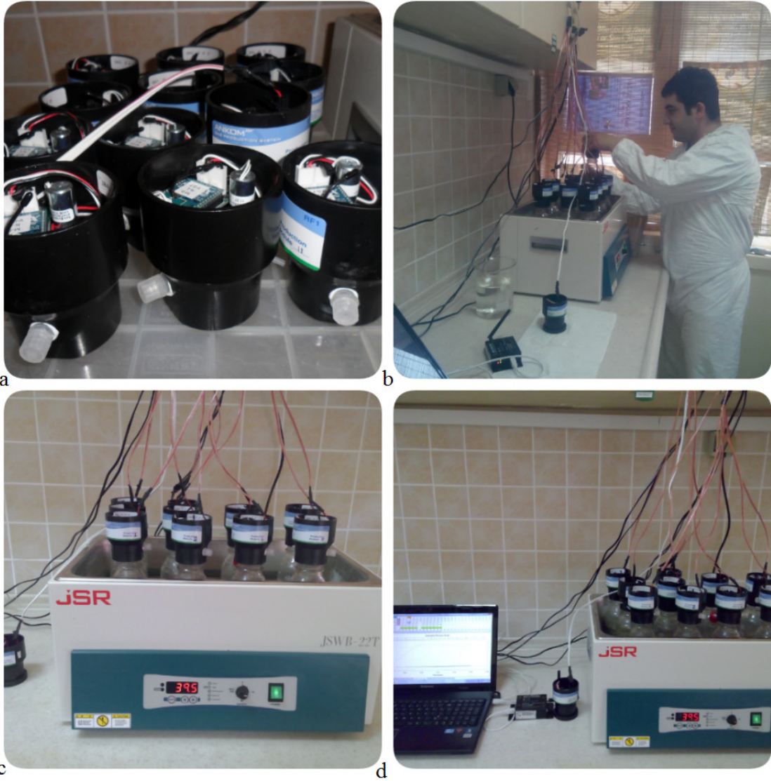
Şekil 3. İn-vitro gaz üretim sisteminde kullanılan modüller (a), modül başlıklarının şişelere takılması (b), su banyosu içine yerleştirilen modüllerin elektrik ve bilgisayar sistemine bağlanması (c), modüllerden gelen verilerin kablosuz dizüstü bilgisayarda kaydedilmesi (d)
