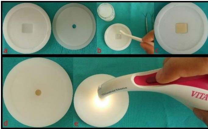
Şekil 22. a. Poliasetat kalıp b. Kalıbın yüzeyine optik solüsyonun sürülmesi c. Seramik örneğin kalıba yerleştirilmesi d. Poliasetat kalıbın konumlandırıcı parçasının yerleştirilmesi ve renk ölçümünün gerçekleştirilmesi
