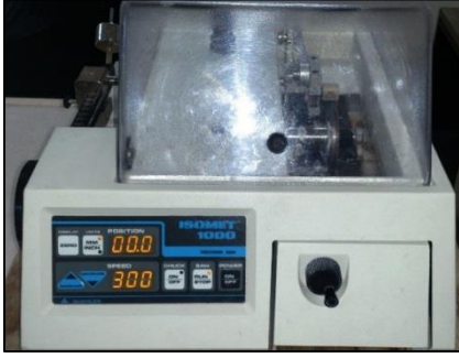
Şekil 12. Kesme işleminin su soğutması altında yapılması
