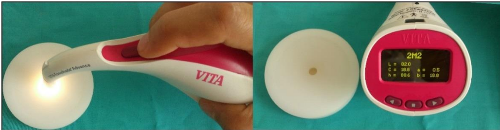
Şekil 30. İkinci spektrofotometrik renk ölçümünün gerçekleştirilmesi
