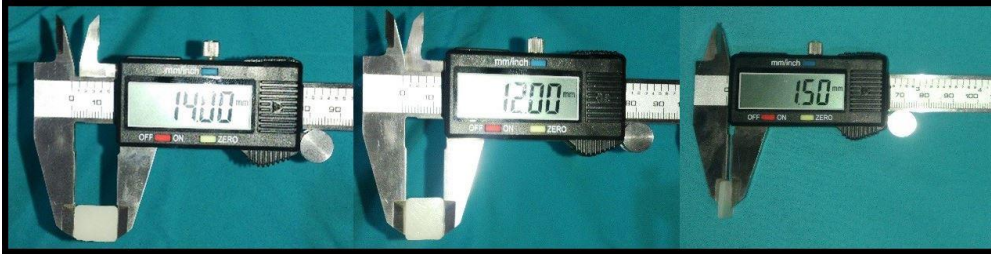
Şekil 20. Seramik örneklerin final boyutları
