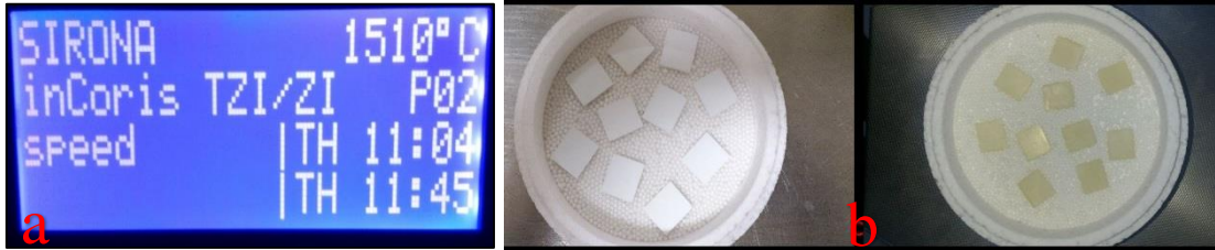
Şekil 18.a. inCoris TZI örneklerin Sinterizasyon Programı b. inCoris TZI örneklerin Sinterizasyon öncesi ve sonrası
