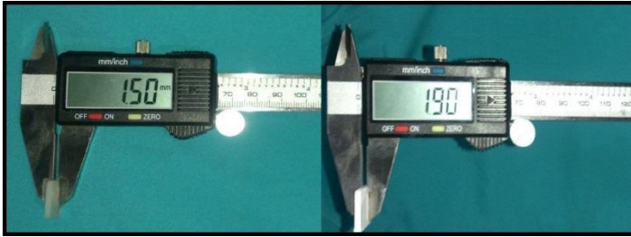
Őekil 15. Aşındırma ve parlatma sonucu elde edilen rnek kalınlıkları
