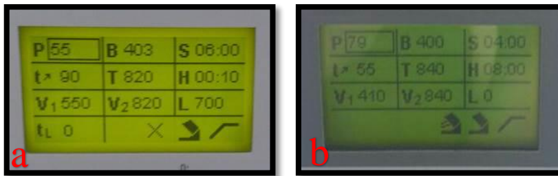
Őekil 16. a. IPS e.max Cad HT rneklerin fırınlama programı b. Vita Suprinity HT rneklerin kristalizasyon programı
