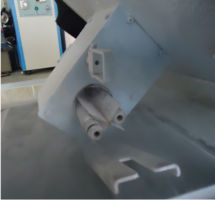
Şekil 20. Kriyojenik pulverizasyon cihazının prosesten hemen sonraki görüntüsü Örnekler, steril edilebilir polikarbonat ve güçlendirilmiş çelik tüplerde dış ortama temas olmaksızın proses edilirler
