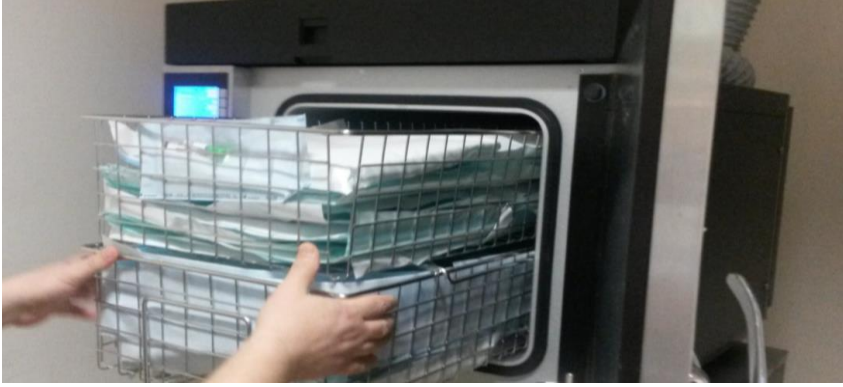
Şekil 19. Malzemelerin Etilen Oksit Cihazına Konulması
