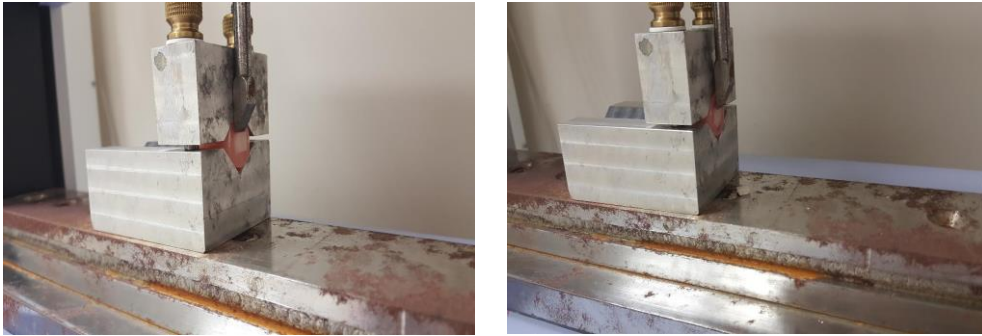
Şekil 23: Örneklere kuvvet uygulanması ve kopma sonrası görüntü
