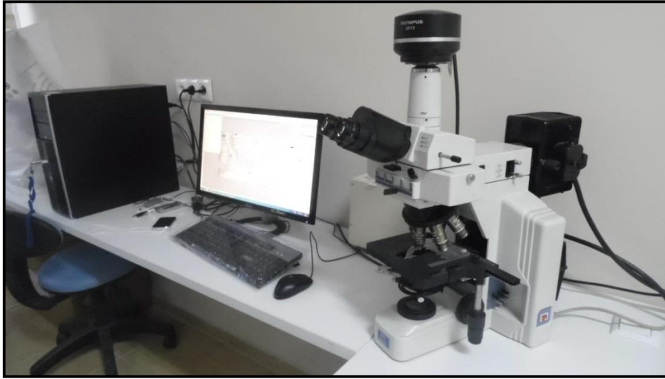
Şekil 3. Çalışmada kullanılan Olympus DP72 digital fotoğraf makinası ataçmanlı Nikon Eclipse E600 mikroskop cihazı (Atatürk Üniversitesi, Tıp Fakültesi, Histoloji ve Embriyoloji ABD)
