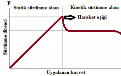
Şekil 4. Sürtünme direnci ile uygulanan kuvvet arasındaki ilişkiyi gösteren grafik
