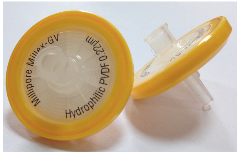
Şekil 21. Elde edilen karışımın steril hale getirilmesi amacıyla kullanılan 33mm çaplı, 0,22µm porlara sahip enjektör filtresi
