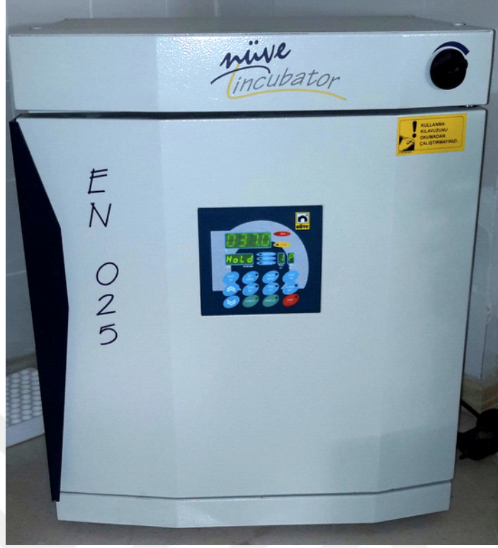
Şekil 20. Elde edilen karışımın 24 saat süreyle 37°C’de bekletilmesi
