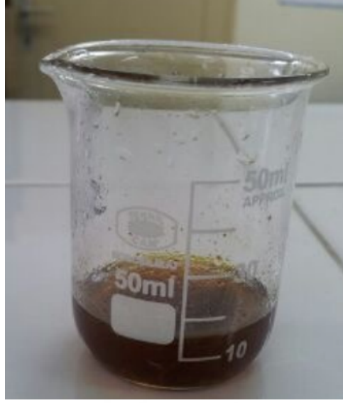
Şekil 23. Aseton-su karışımının üzüm çekirdekleri üzerine eklenmesi
