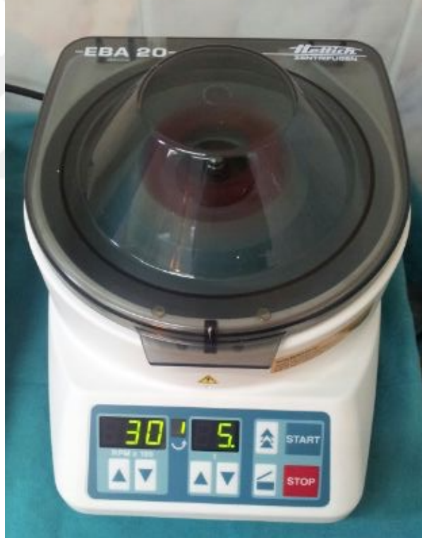
Şekil 24. Karışımın berrak hale gelmesi için 3000 rpm'de 5 dk boyunca santrifüj edilmesi
