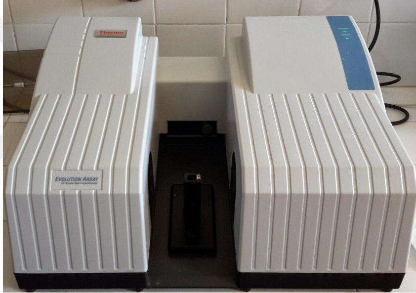
Şekil 26. Çözeltilerin 517 nm’de absorbans ölçümlerinin yapılması
