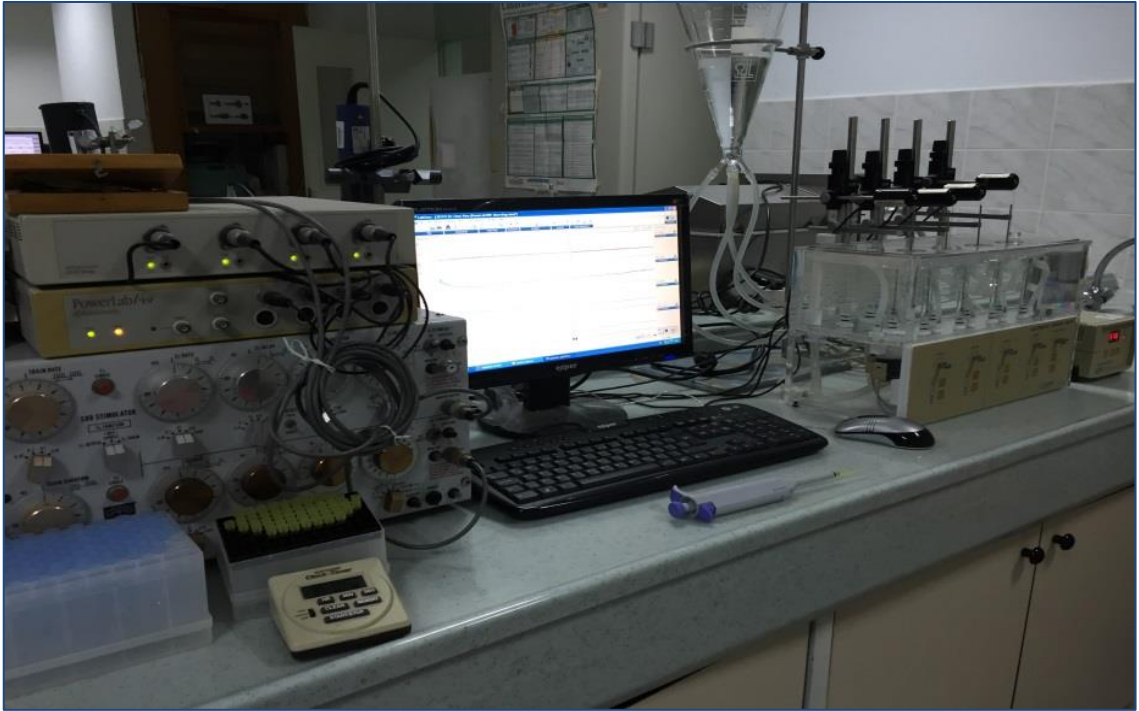
Şekil 21. In vitro deneyler için kullanılan PowerLab veri kazanım sistemine entegre organ banyosu sistemi
