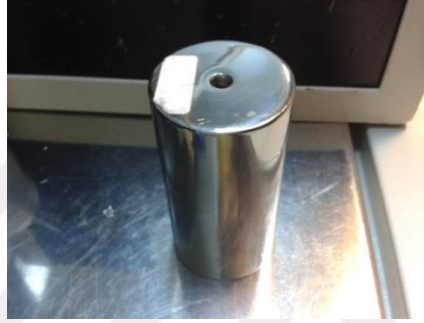
Şekil 19. İçine vakumlu şişe yerleştirilip radyonüklid jeneratöründen teknesyum sağlamak için kullanılan ve vakumlu şişedeki radyasyonun çevreye yayılmasını engelleyen kurşun koruyucu zırh
