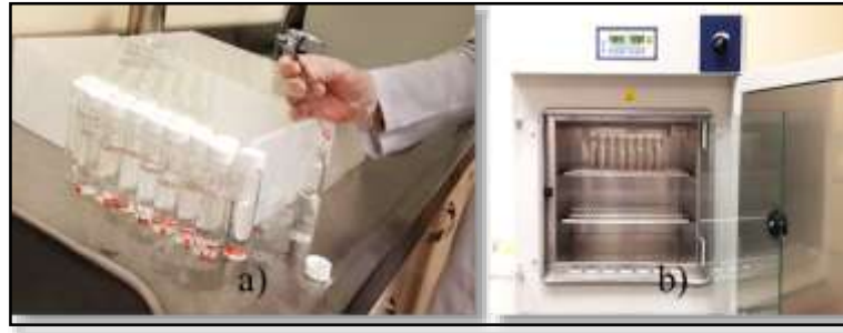
Şekil 16. a) Örneklerin yapay tükürük içerisine konulması b) Etüv içerisinde 37°C'de 30 dk bekletilmesi
